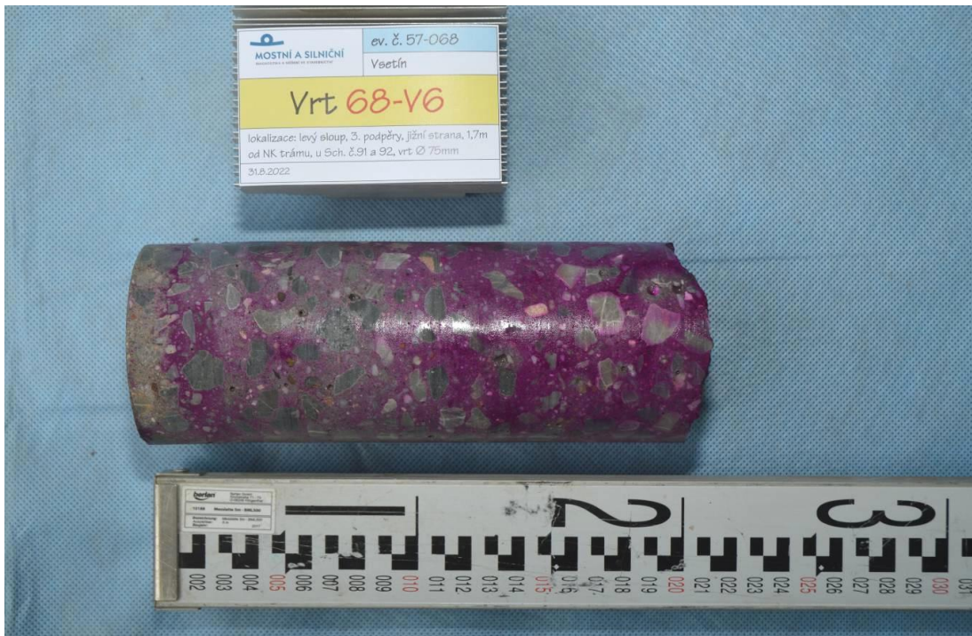
Obr. 3.62: Jádrový vývrt z levého sloupu 3. podpěry [25]
