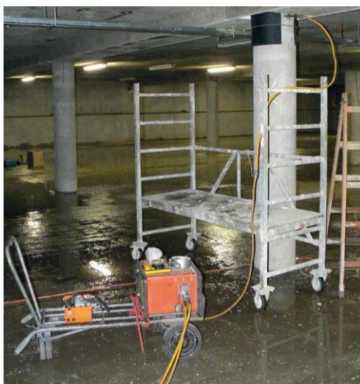
← Obr. 2.3: Provádění radiografie zářičem Co60 [15]
