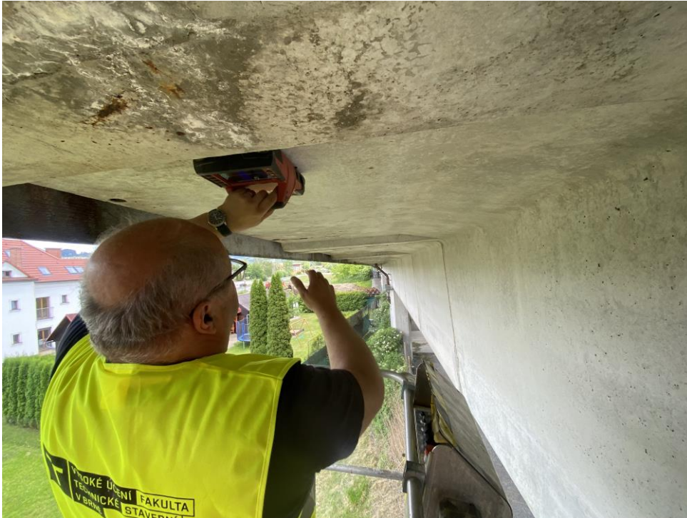
Obr. 3.33: Provádění liniového skenu na levé konzole lamely typu DS-T
