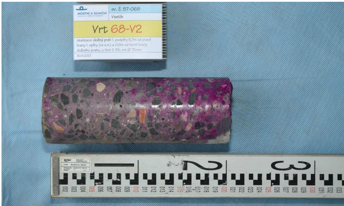
Obr. 3.58: Jádrový vývrt z úložného prahu 1. opěry [25]
