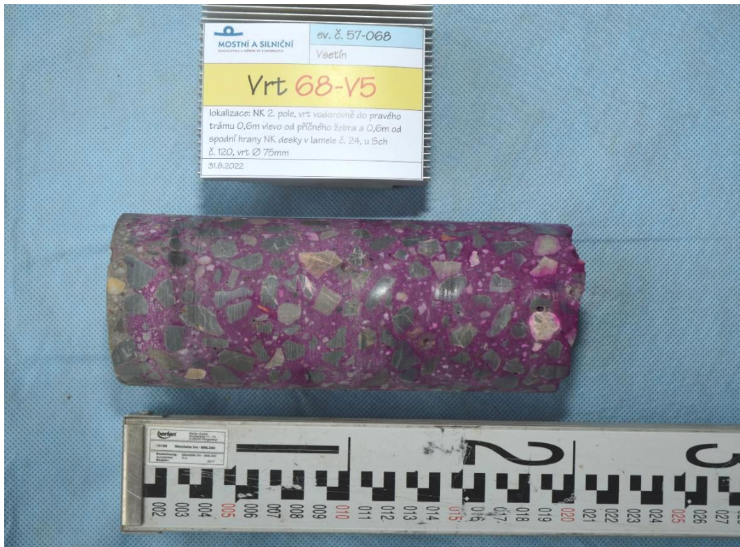
Obr. 3.60: Jádrový vývrt z pravého trámu 24. lamely [25]
