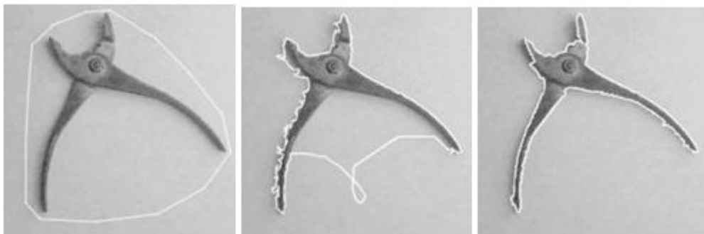
Obr. 3.10: Nevýhoda algoritmu aktivních kontur a její odstranění. Převzato z [1].
