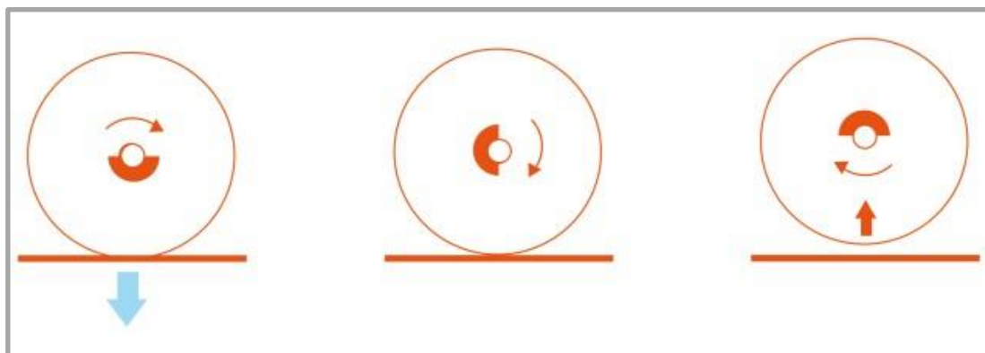
Obr. 2-11 Schéma kmitania behúňa rotujúcim excentrickým závažím [18]
