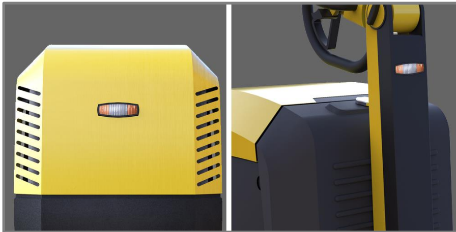
Obr. 6-8 Detail dvojice IR prijímačov umiestnených na stroji
