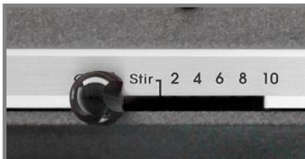
Obr. 13 Ovládání rychlosti pomocí posuvného ovladače [19]
