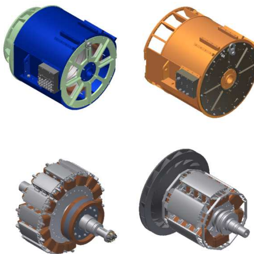
Obrázek 51 – Model statoru a rotoru po aplikaci materiálů
