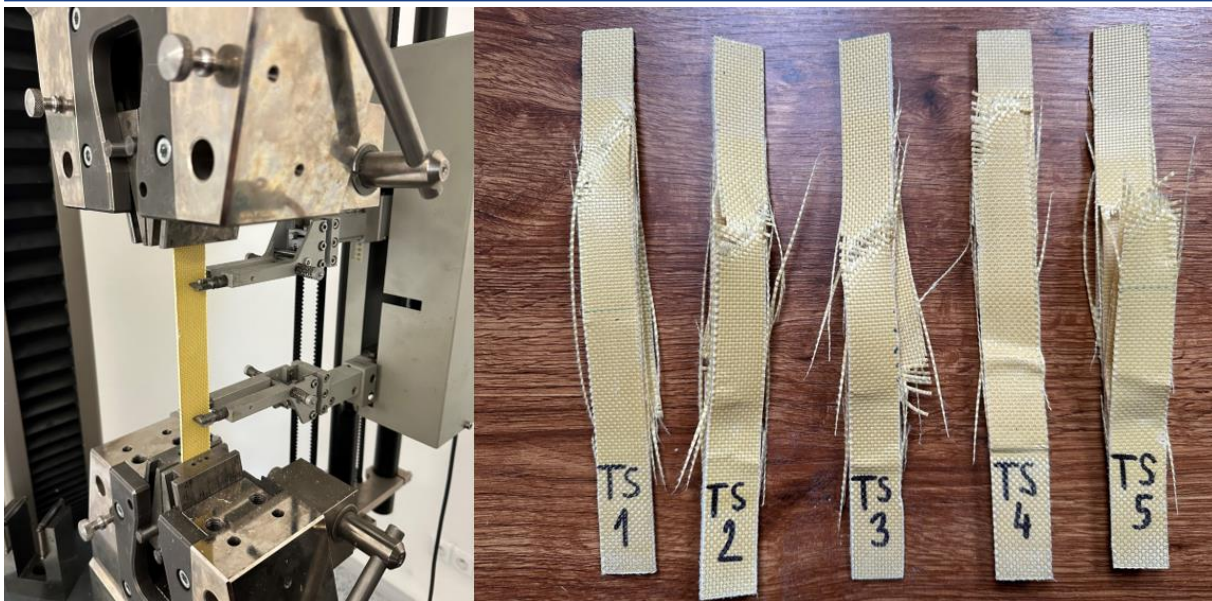
Obr. 54 Průběh tahové zkoušky a termosetové vzorky po zkoušce.
