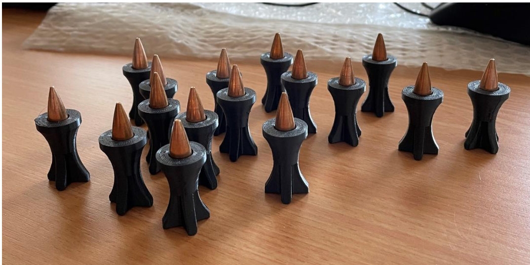
Obr. 65 Připravené impaktory v unašečích.
