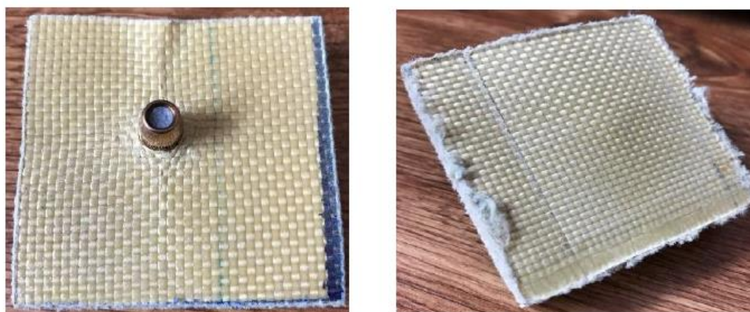
Obr. 69 Přední a zadní strana vzorku B1 po testu.
