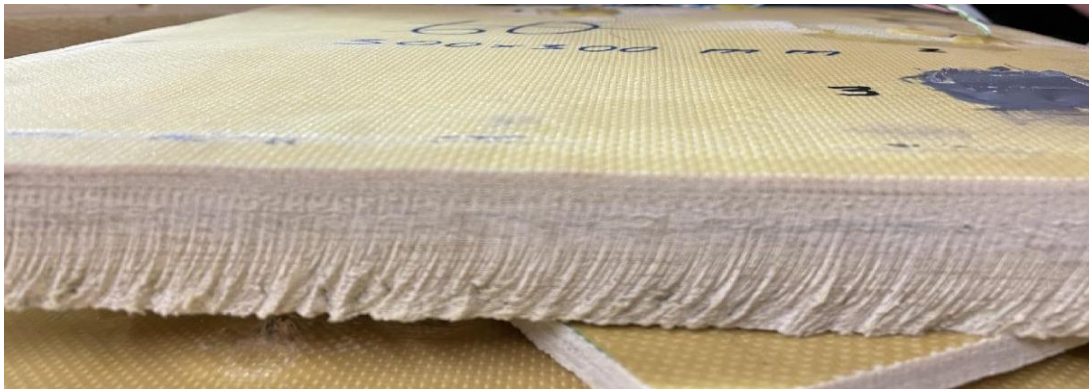
Obr. 48 Detail řezu twaronového panelu vodním paprskem.
