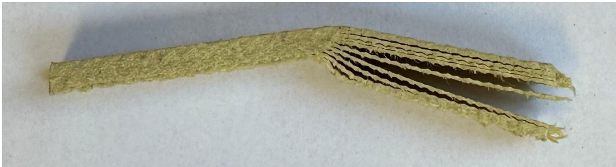
Obr. 27 Delaminace aramidového kompozitu.
