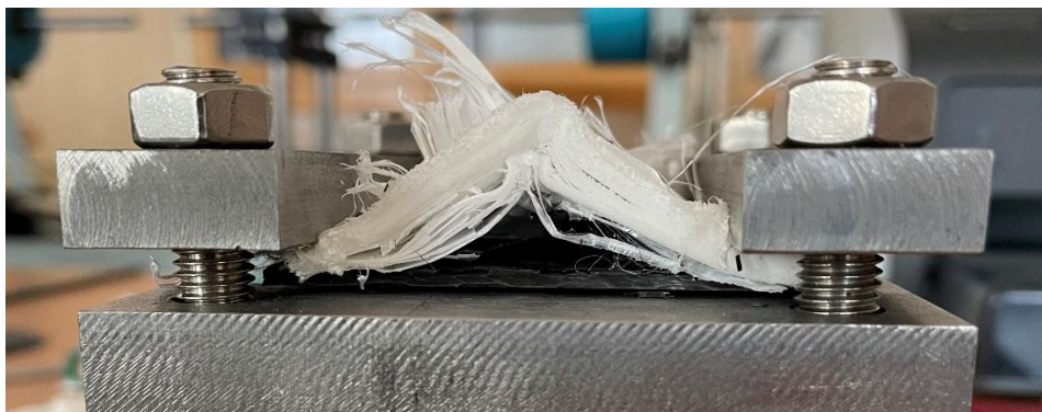
Obr. 72 Detail delaminace Endumaxu.
