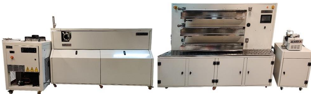
Obr. 17 Zařízení Wet Spinner pro mokré zvlákňování [32].
