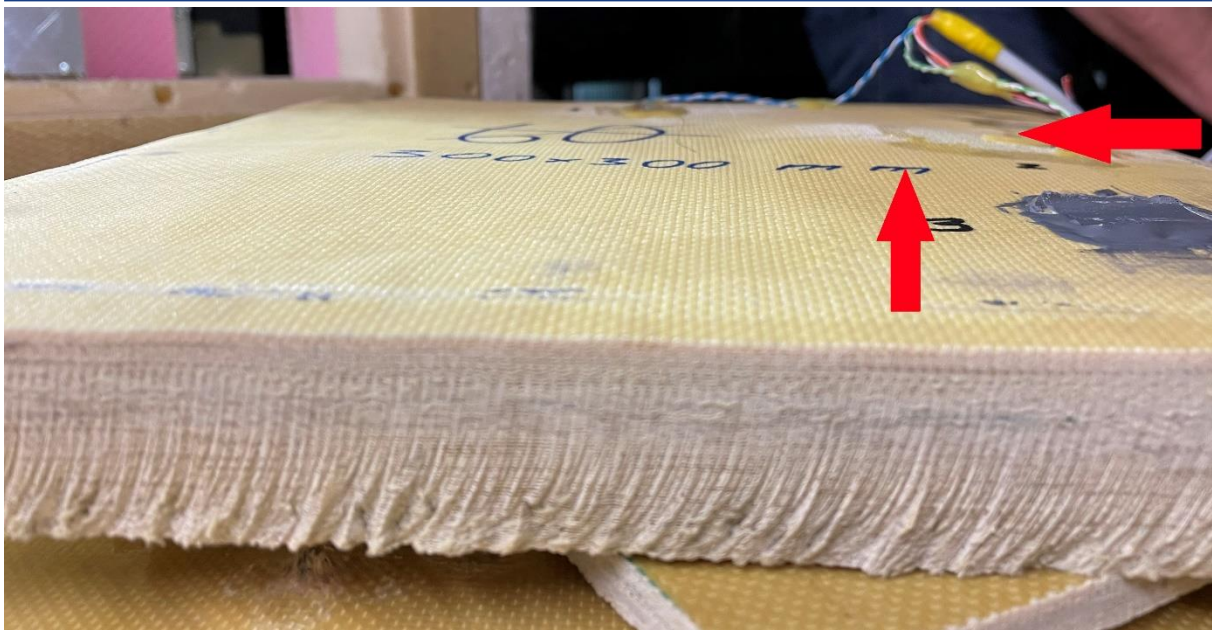
Obr. 75 Označení místa s vyboulením po balistické zkoušce.
