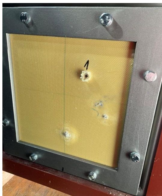
Obr. 74 Panel s maticí LG 700 (90 vrstev) po prvním výstřelu.
