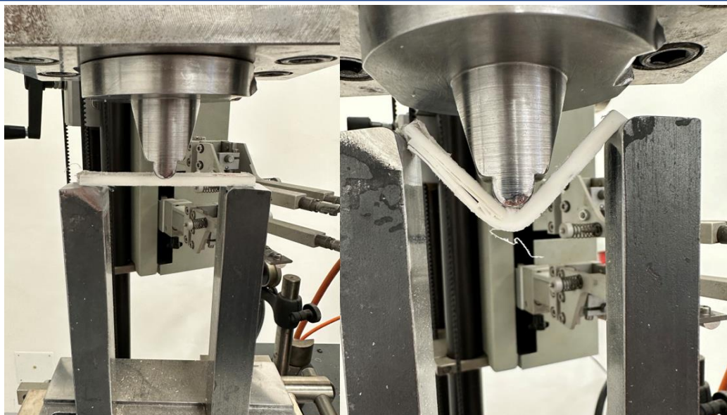
Obr. 57 Průběh ohybové zkoušky.
