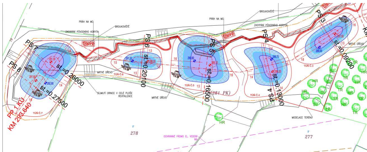
Obrázek 42 Část situace C.3.1 ukazující půdorys tůní [Růžička 2022]
