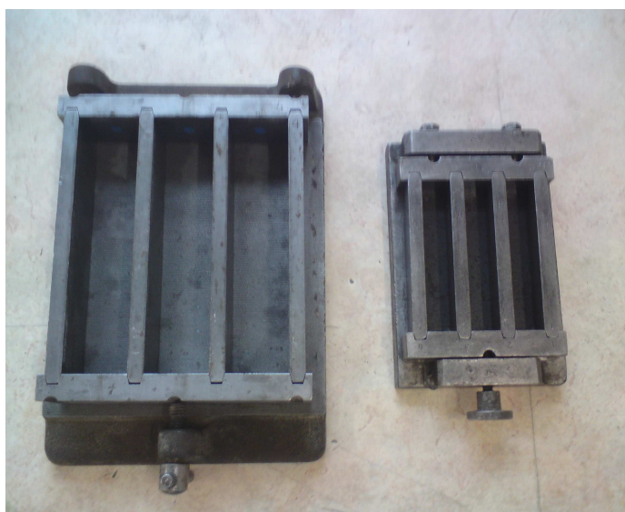
Obrázek 5 Trámečky pro přípravu vzorků (vlevo 40x40x160mm, vpravo 20x20x100mm)
