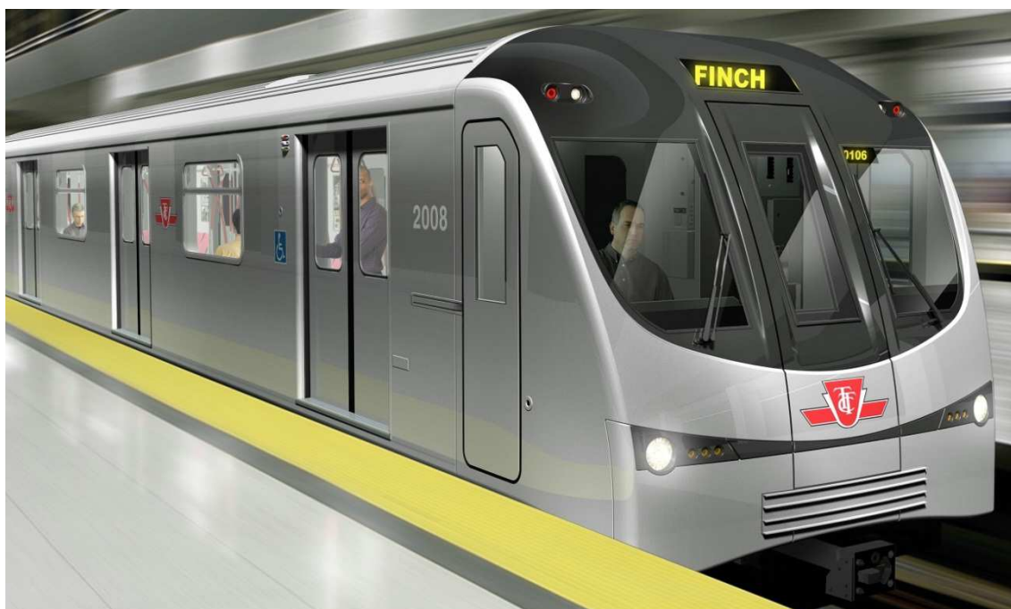
Obr. 4 Posuvné dveře vlaku metra firmy Bombardier [21].
