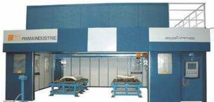
Obr. 2.20 3D/2D 5-osé Obráběcí laserové centrum Optimo od společnosti PRIMA North America, Inc. s integrovanou laserovou hlavou (21)
