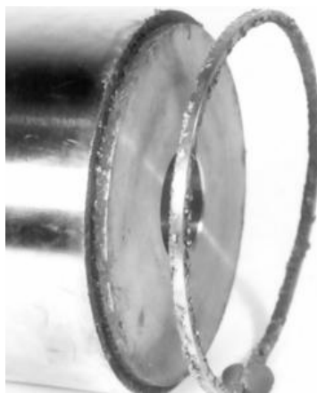
Obr. 2.52 Ukázka laserového soustružení prstencovým úběrem materiálu (3)
