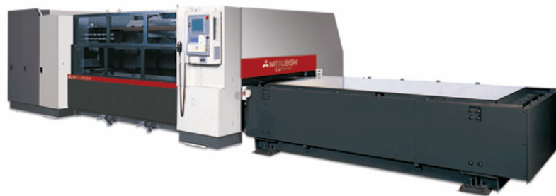
Obr. 2.22 2D 5-osé obráběcí centrum LVPlus II Series od společnosti MC Machinery Systems, Inc. , pracující s laserem plynovým CO 2 (20)
