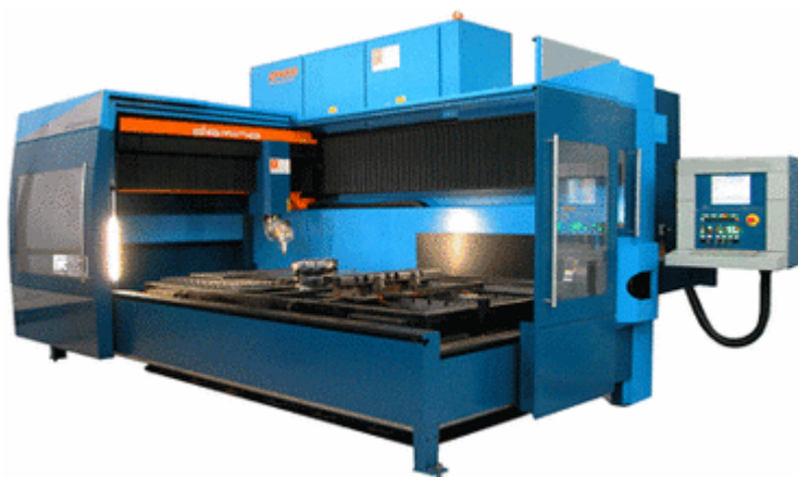
Obr. 2.19 3D/2D Obráběcí laserové centrum Domino od společnosti PRIMA North America, Inc. s integrovanou laserovou hlavou (Nd:YAG, CO 2 aj.) volenou dle aplikace (21)
