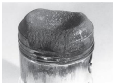
Obr. 6 Predieravenie piestu spôsobené predbežným zapalovaním. [2]
