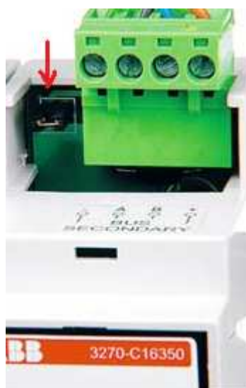
Obr. 2.2.3 -4 Jumper zakončovacího odporu sekundární sběrnice [1]
