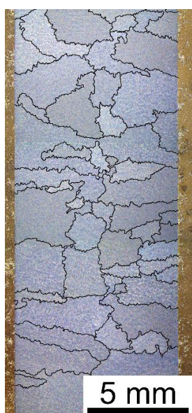
a) Makrostruktura – řez zkušebním tělesem; SM.
