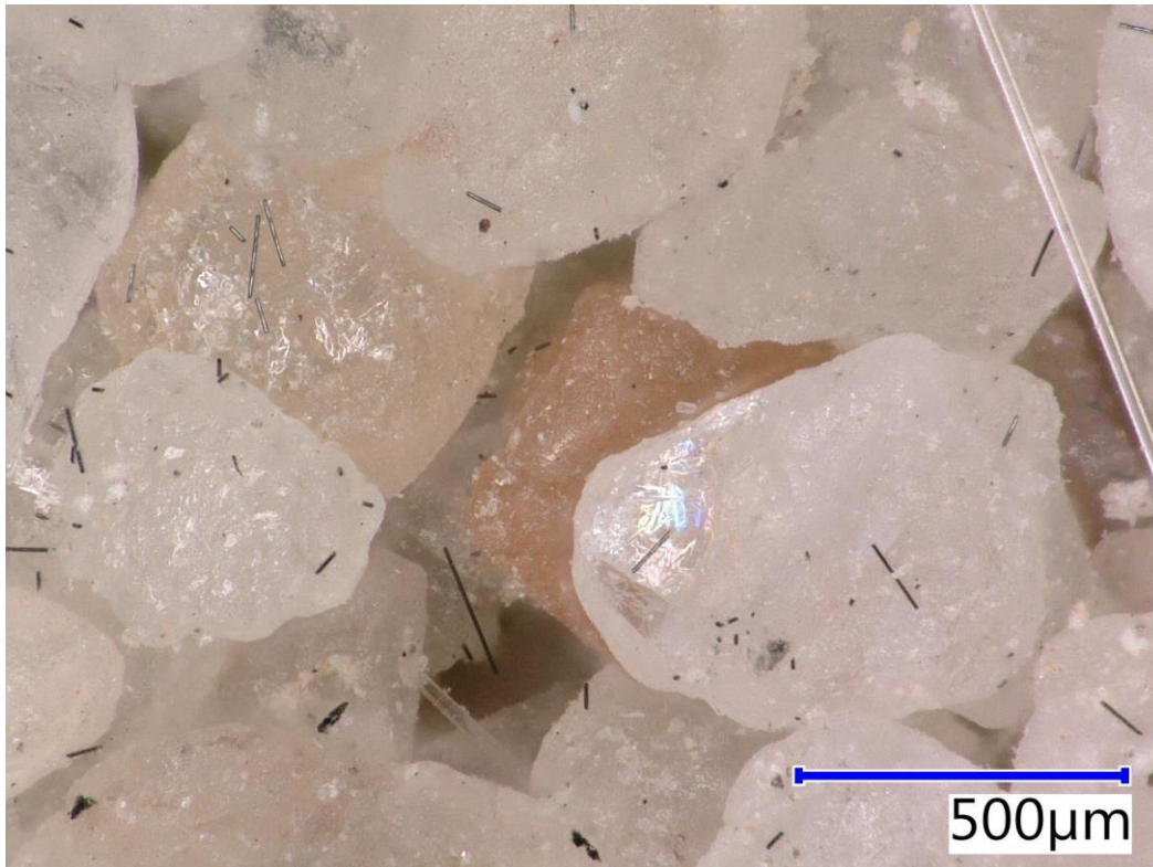
Obr. 60 - Opískování křemičitým pískem odloučené z GFRP výztuže po působení teploty 600 °C
