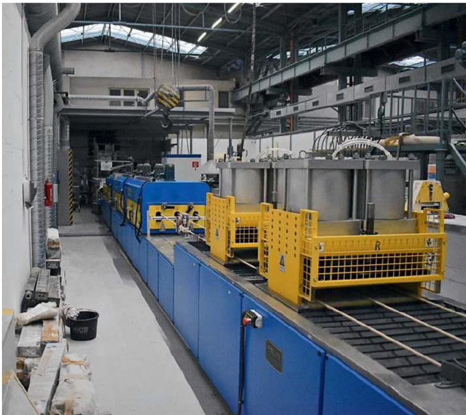
Obr. 5 - Linka na výrobu FRP kompozitních výztuží, Prefa Kompozity a.s. [21]
