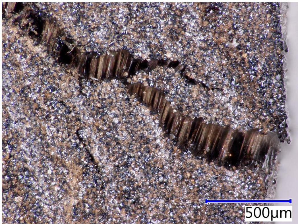
Obr. 55 - Pohled kolmo na směr vláken, vlákna a křemičité opískování na průřezu GFRP kompozitní výztuže po působení teploty 400 °C
