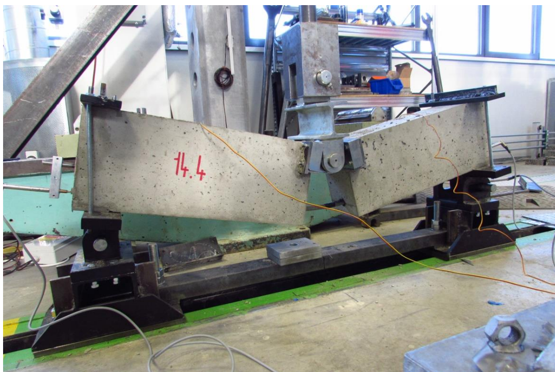
Obr. 30 - Porušení nosníku s GFRP kompozitní výztuží po zkoušce cyklickým zatěžováním
