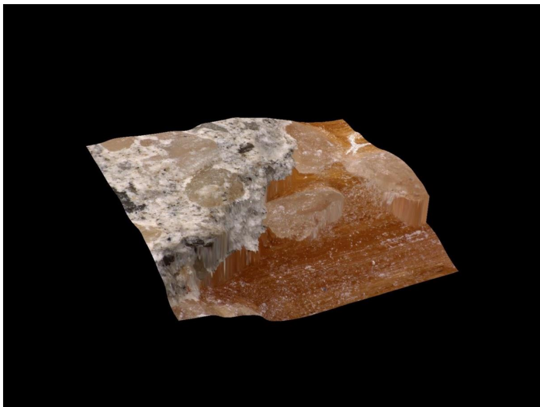
Obr. 49 - 3D pohled na GFRP kompozitní výztuž s betonem
