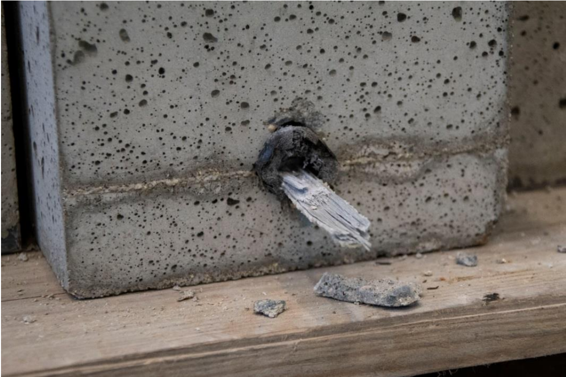
Obr. 35 - Detail porušení FRP kompozitní výztuže v betonovém bloku po zkoušce cyklickým zatěžováním – porušení výztuže
