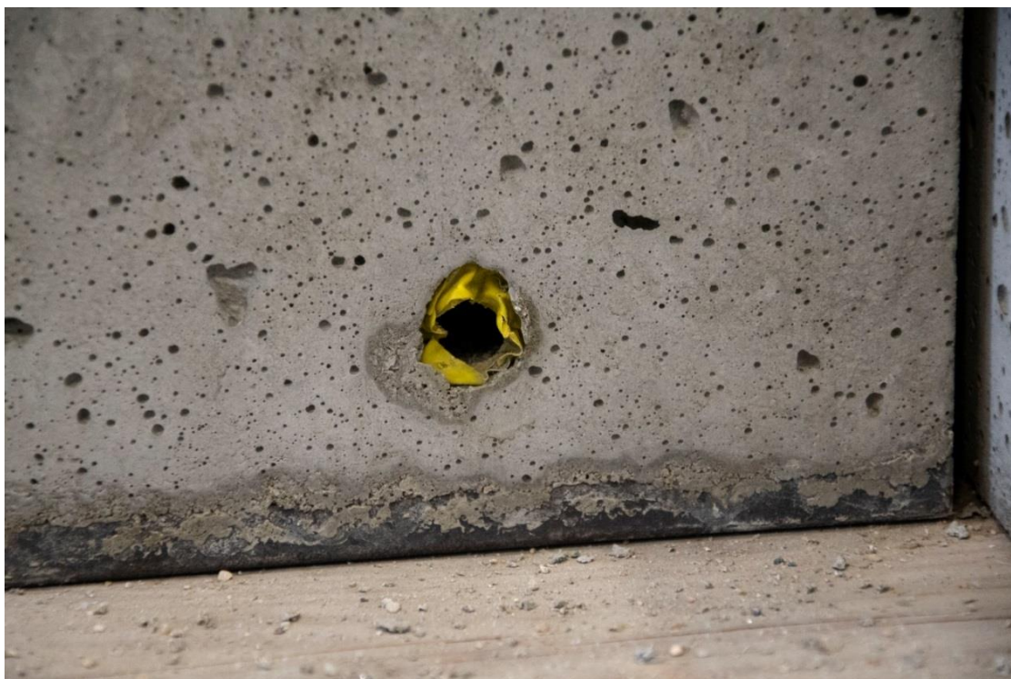
Obr. 36 - Způsob porušení FRP kompozitní výztuže v betonovém bloku po zkoušce cyklickým zatěžováním – vytažení výztuže
