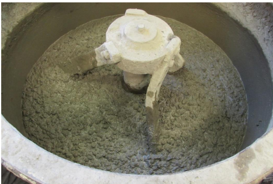
Obr. 27 - Čerstvý beton pro výrobu nosníků
