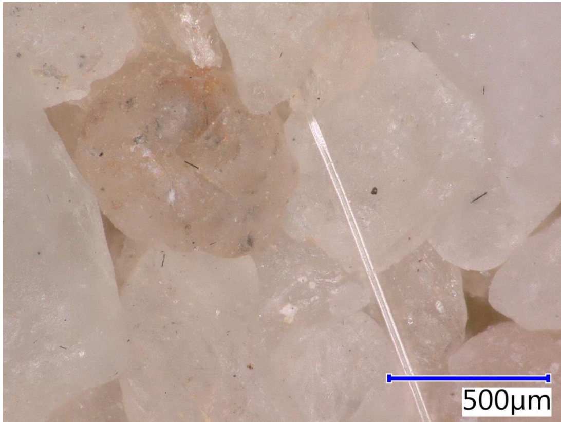
Obr. 64 - Opískování křemičitým pískem odloučené z GFRP výztuže po působení teploty 800 °C.
