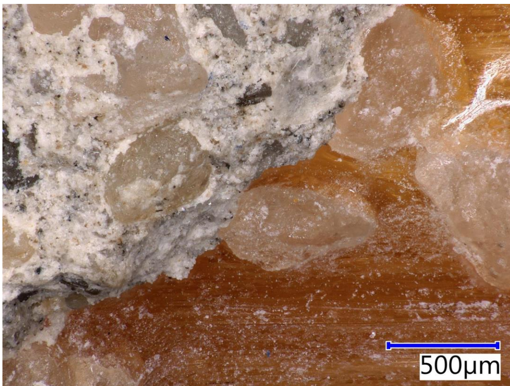
Obr. 48 - Beton na GFRP kompozitní výztuži po zkoušce cyklického namáhání
