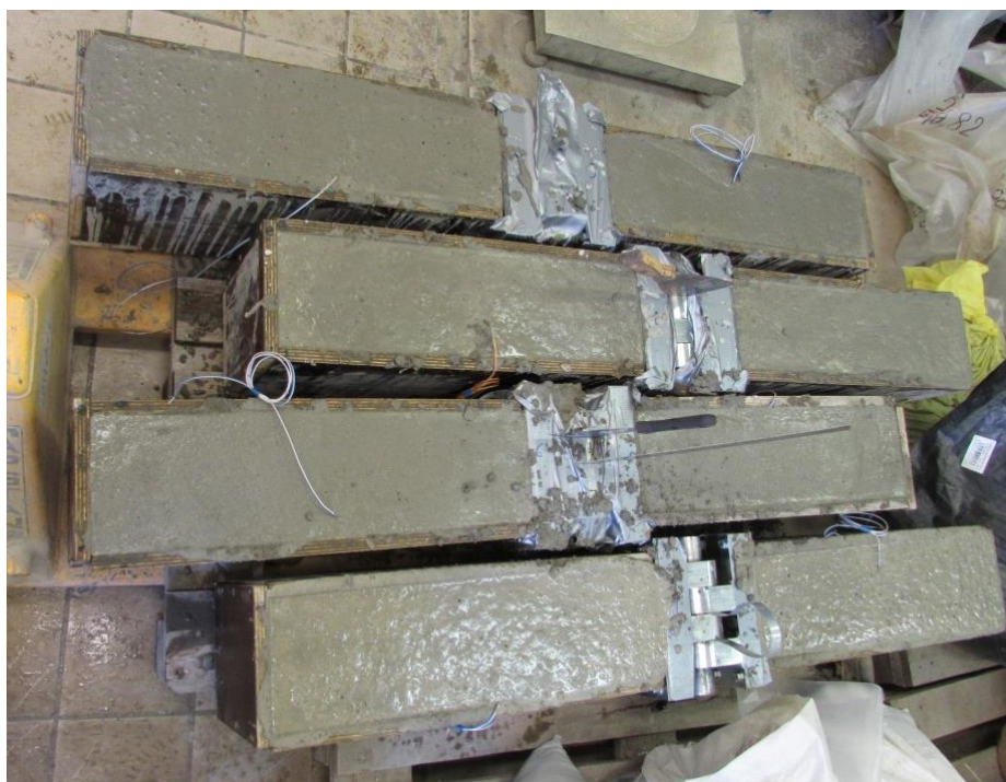
Obr. 28 - Nosníky se zabetonovanou GFRP kompozitní výztuží
