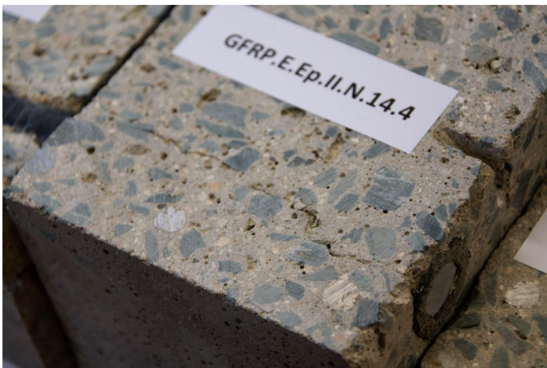
Obr. 37 - Trhlina v betonovém nosníku v blízkosti GFRP výztuže po zkoušce cyklickým zatěžováním
