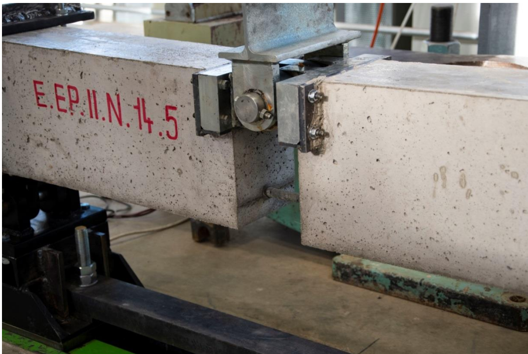
Obr. 29 - Upevnění nosníku do zařízení pro zkoušku cyklickým zatěžováním
