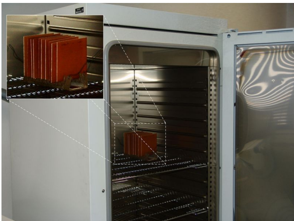
Obrázek 6: Umístění vzorků v laboratorní sušce Venticell v průběhu zrychleného tepelného stárnutí
