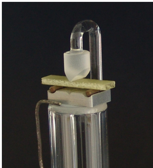
Obrázek 8: Uspořádání sondy a testovaného vzorku pro třibodový ohyb
