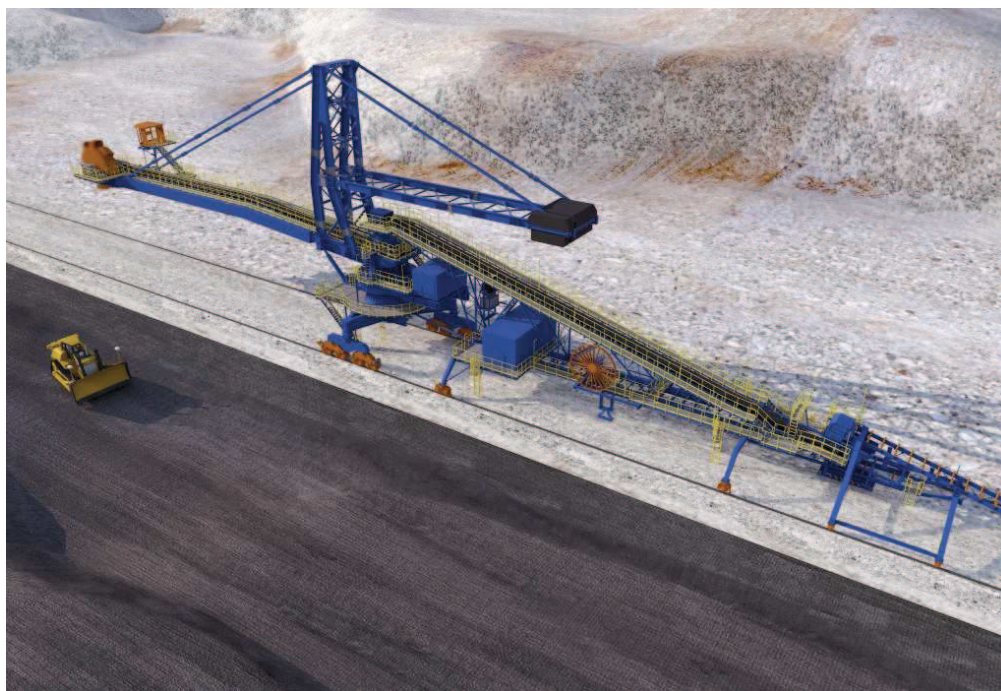
Obr. 1 Kombinovaný skládkový stroj ZNKk 13x10-46 [20]
