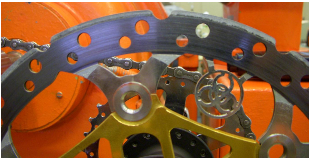
Obr. 31 Stav brzdového kotouče po sedmém bodě měření a teplotě 1016°C
