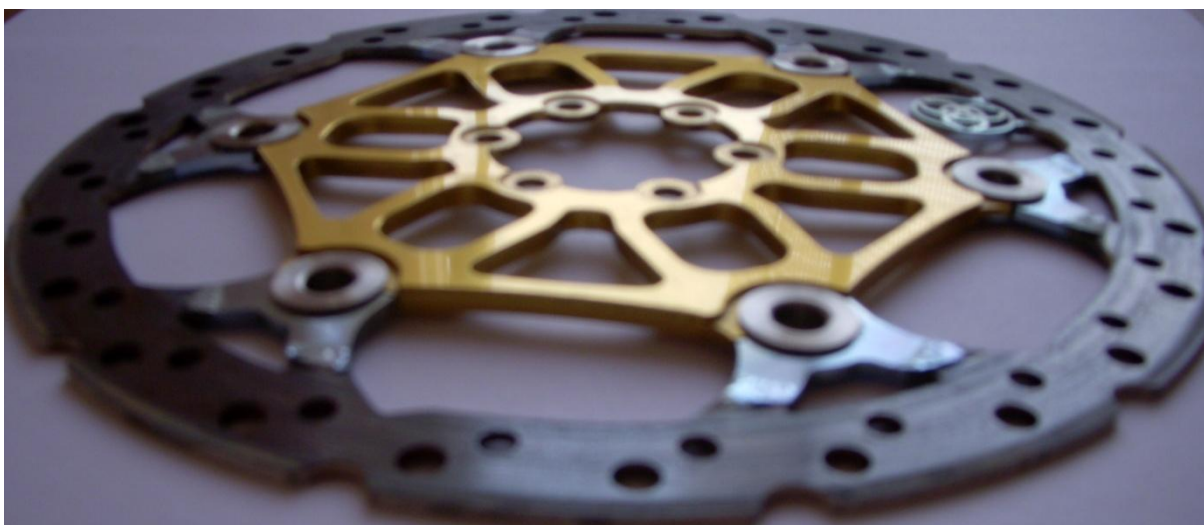
Obr. 30 Konečný stav brzdového kotouče po ukončení experimentu
