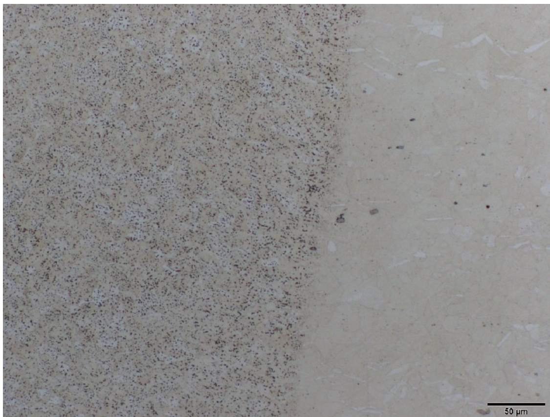
Obr. P4.3 Mikrostruktura svar. spoje - AZ31 (tl. 1,6 mm - podélný směr) – místo B, lept. acetic picral
