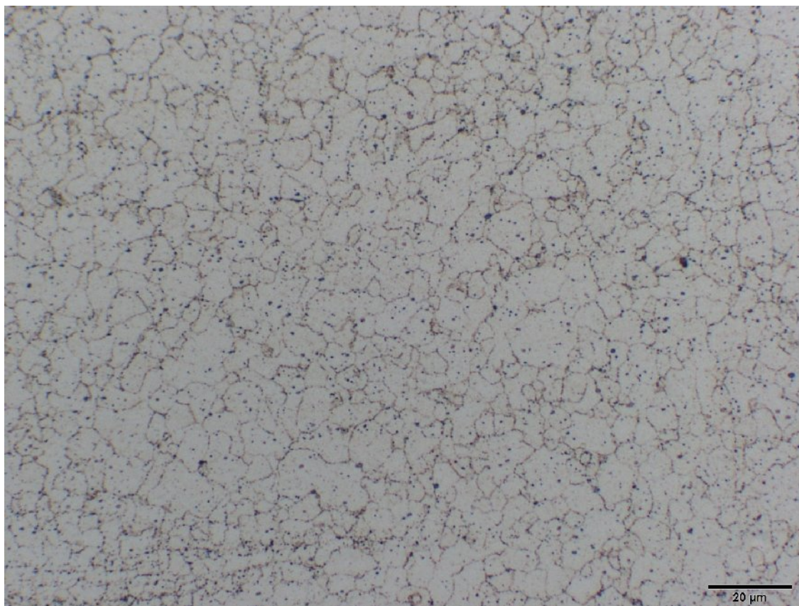
Obr. P2.22 Mikrostruktura svar. spoje I – AZ61 (tl. 0,8 mm – příčný směr) – oblast B, lept. nital
