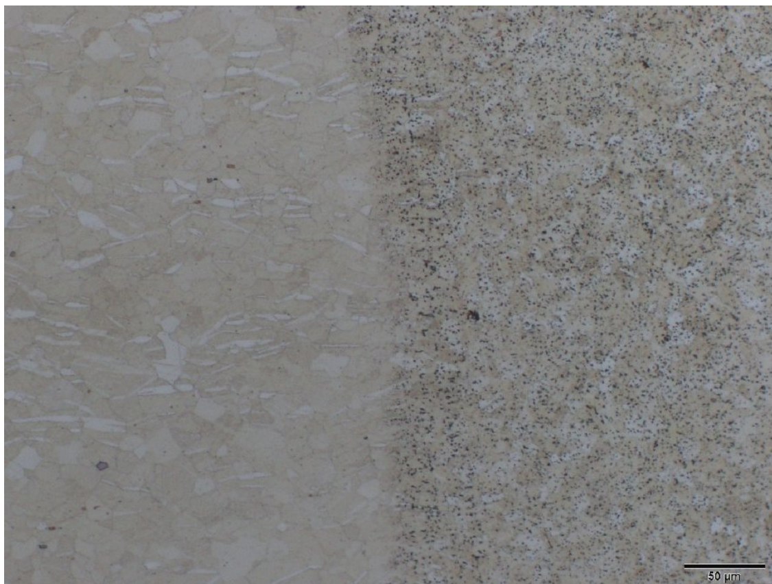
Obr. P4.10 Mikrostruktura svar. spoje - AZ31 (tl. 1,6 mm - příčný směr) – místo C, lept. acetic picral
