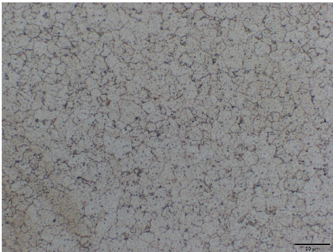
Obr. P2.19 Mikrostruktura svar. spoje – AZ61 (tl. 0,8 mm – podélný směr) – oblast A, lept. nital
