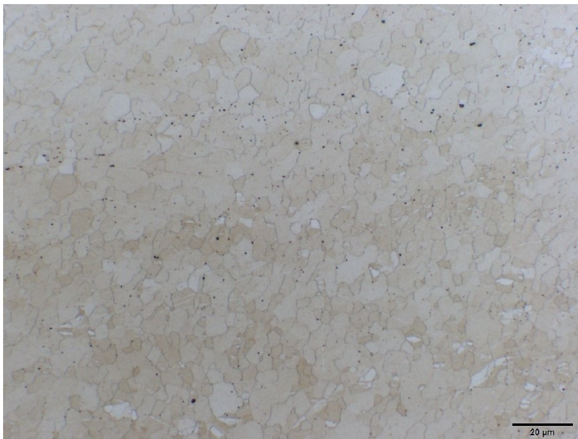
Obr. P2.25 Mikrostruktura svar. spoje – ZE10 (tl. 1,6 mm – podélný směr) – oblast A, lept. acetic picral
