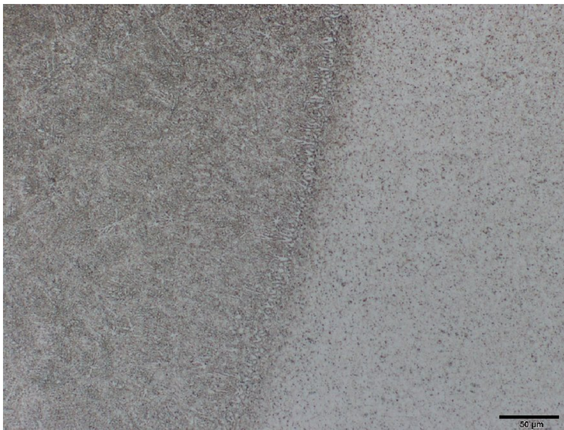
Obr. P4.17 Mikrostruktura svar. spoje - AZ61 (tl. 0,8 mm - příčný směr) – místo B, lept. nital
