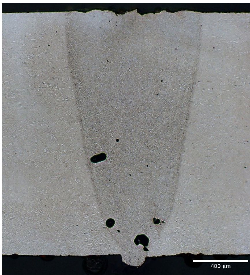
Obr. P4.1 Vzhled svarového spoje, AZ31 (tl. 1,6 mm - podélný směr), lept. acetic picral
