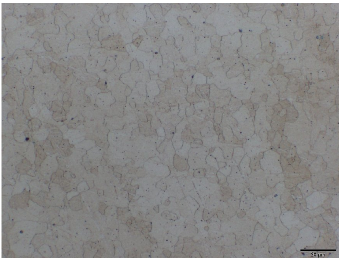
Obr. P2.1 Mikrostruktura svar. spoje - AZ31 (tl. 1,6 mm - podélný směr) – oblast A, lept. acetic picral
