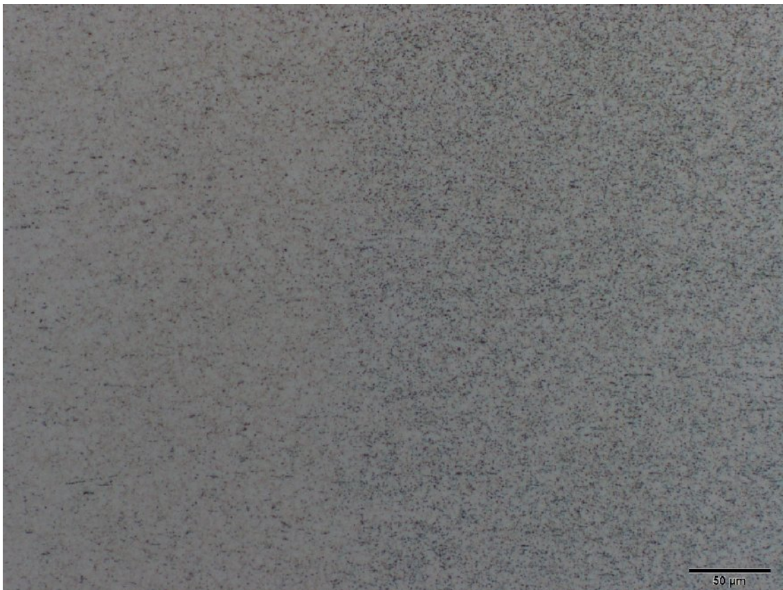
Obr. P3.19 Mikrostruktura svar. spoje - AZ61 (tl. 0,8 mm - podélný směr) – místo D, lept. nital
