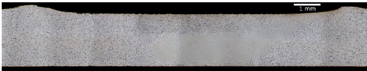
Obr. P2.40 Vzhled svarového spoje, ZE41 (tl. 2 mm - příčný směr), lept. nital
