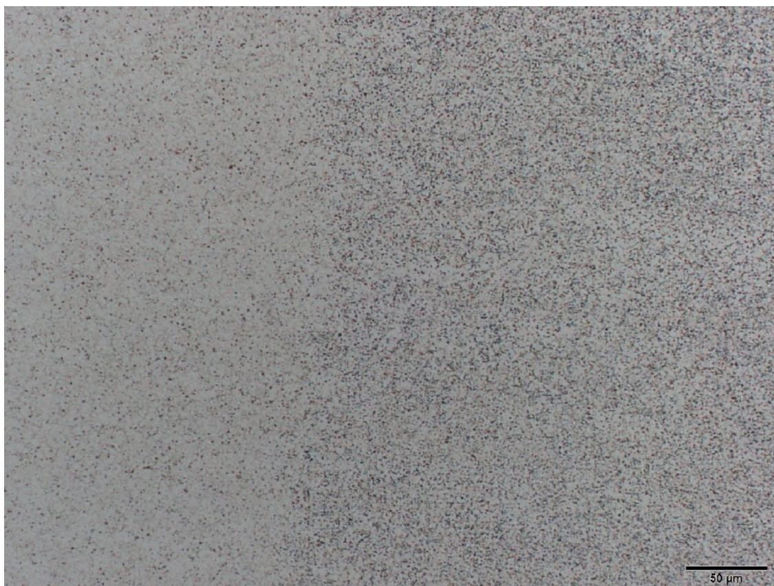
Obr. P3.23 Mikrostruktura svar. spoje - AZ61 (tl. 0,8 mm - příčný směr) – místo D, lept. nital
