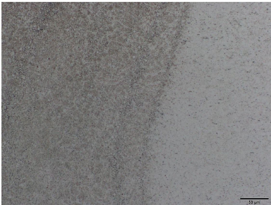
Obr. P3.17 Mikrostruktura svar. spoje - AZ61 (tl. 0,8 mm - podélný směr) – místo B, lept. nital
