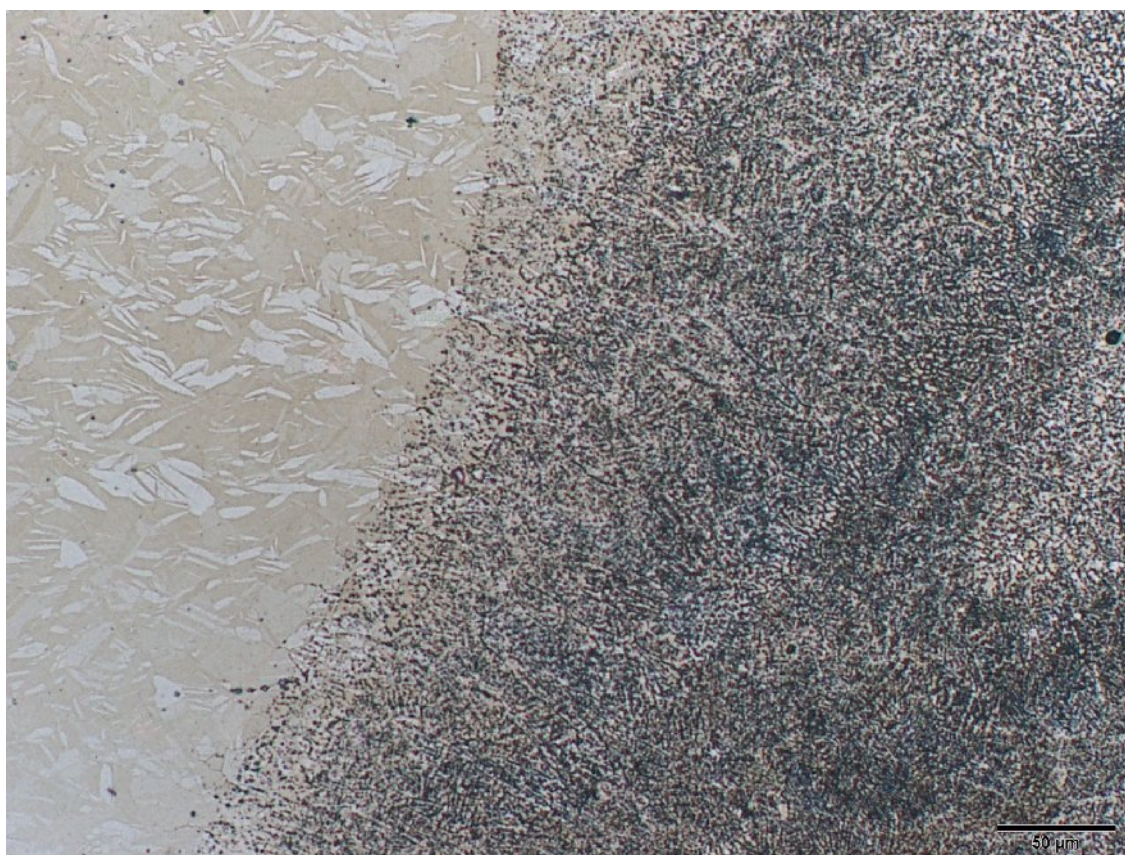
Obr. P3.9 Mikrostruktura svar. spoje I - AZ31 (tl. 1,6 mm - příčný směr) – místo C, lept. acetic picral
