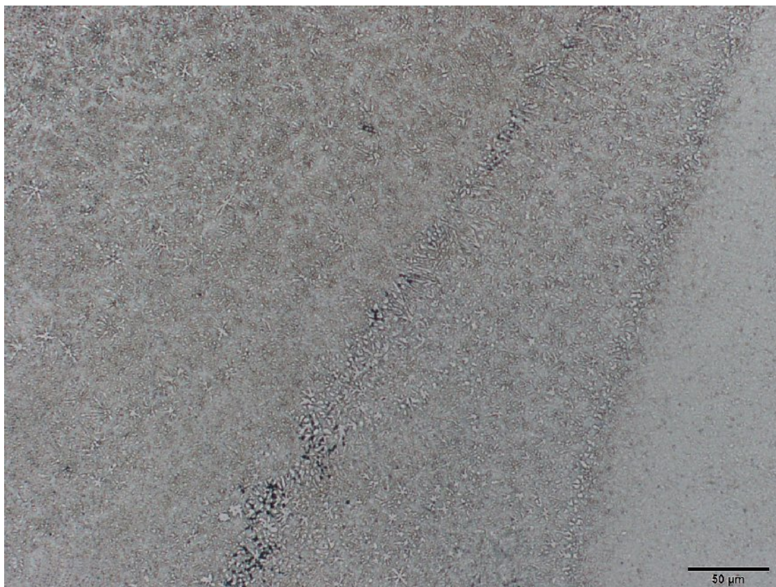
Obr. P3.22 Mikrostruktura svar. spoje - AZ61 (tl. 0,8 mm - příčný směr) – místo B, lept. nital
