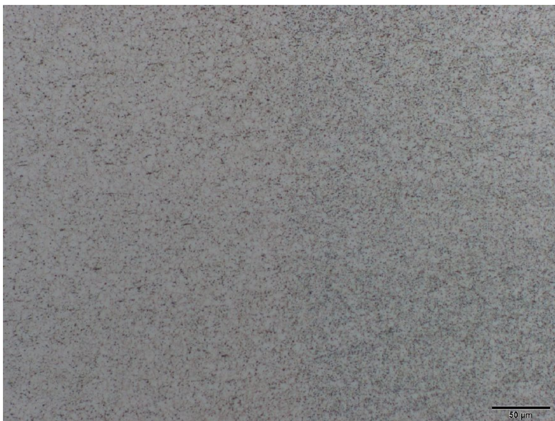
Obr. P4.14 Mikrostruktura svar. spoje - AZ61 (tl. 0,8 mm - podélný směr) – místo D, lept. nital
