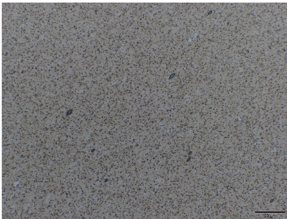
Obr. P2.35 Mikrostruktura svar. spoje - ZE41 (tl. 2 mm - podélný směr) – místo E, lept. acetic picral
