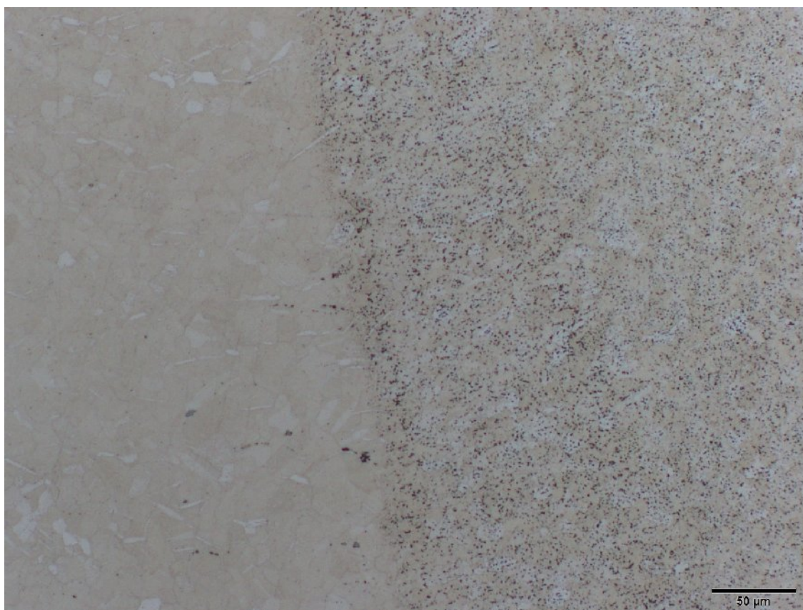
Obr. P4.4 Mikrostruktura svar. spoje - AZ31 (tl. 1,6 mm - podélný směr) – místo C, lept. acetic picral
