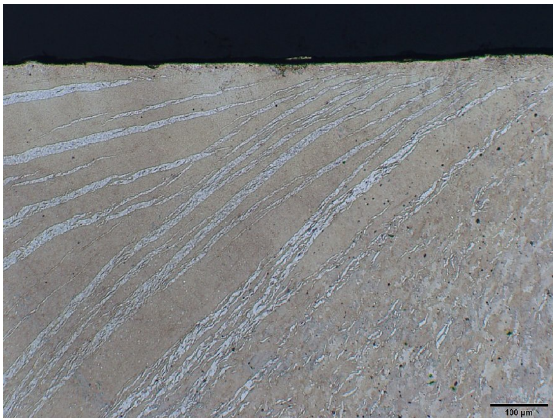
Obr. P2.31 Mikrostruktura svar. spoje – ZE10 (tl. 1,6 mm – příčný směr) – oblast C, lept. acetic picral
