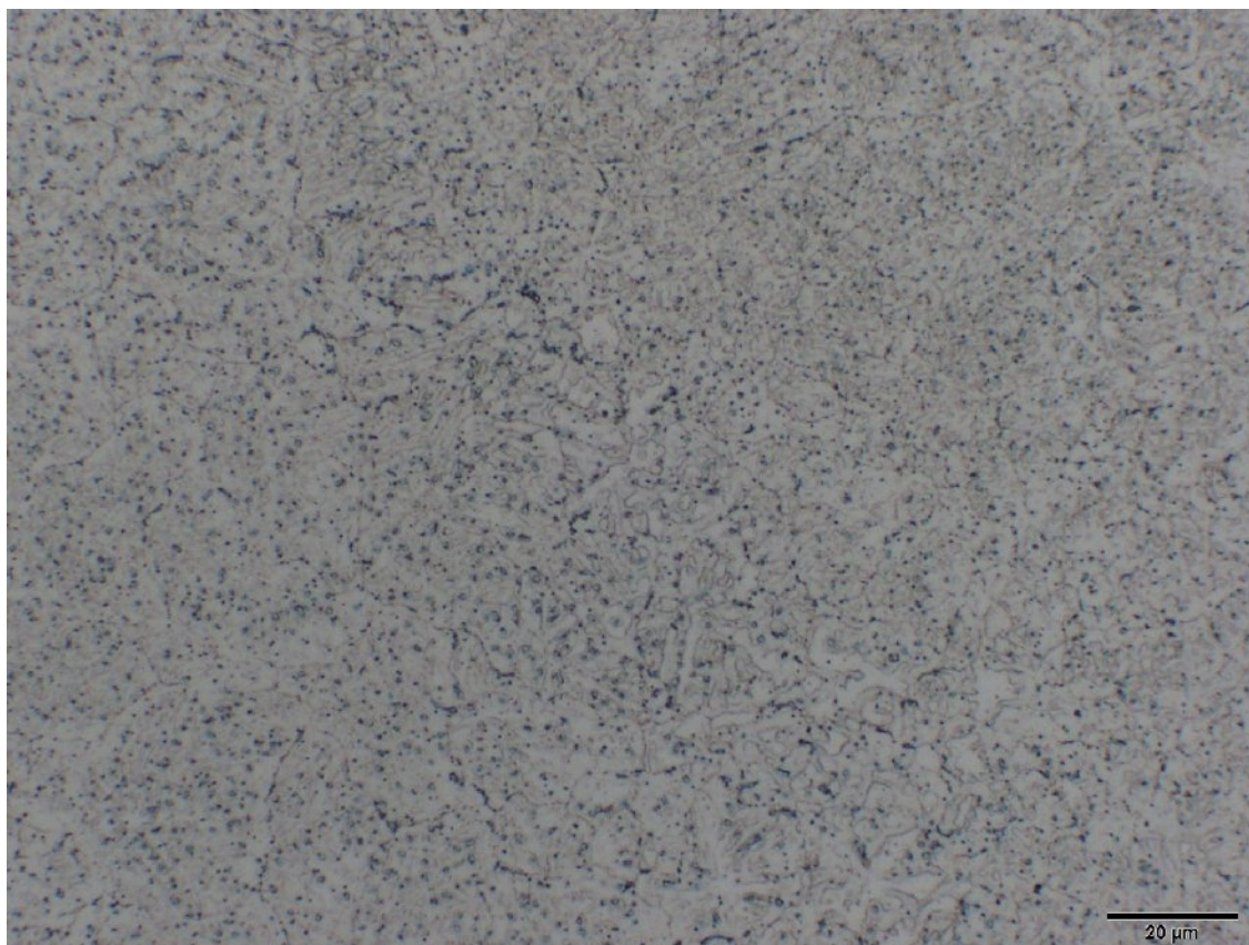
Obr. P3.15 Mikrostruktura svar. spoje - AZ61 (tl. 0,8 mm - podélný směr) – místo A, lept. nital
