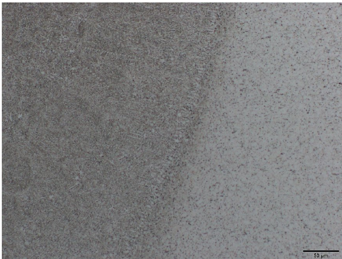
Obr. P4.13 Mikrostruktura svar. spoje - AZ61 (tl. 0,8 mm - podélný směr) – místo B, lept. acetic picral
