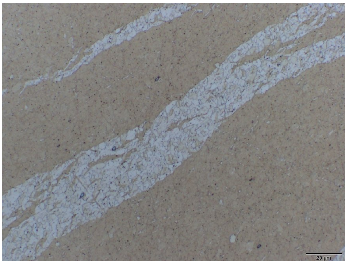
Obr. P2.30 Mikrostruktura svar. spoje – ZE10 (tl. 1,6 mm – příčný směr) – oblast B, lept. acetic picral
