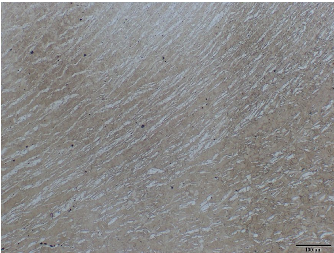
Obr. P2.3 Mikrostruktura svar. spoje - AZ31 (tl. 1,6 mm - podélný směr) – oblast C, lept. acetic picral
