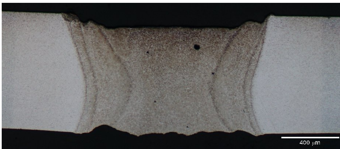
Obr. P3.14 Vzhled svarového spoje, AZ61 (tl. 0,8 mm - podélný směr), lept. nital
