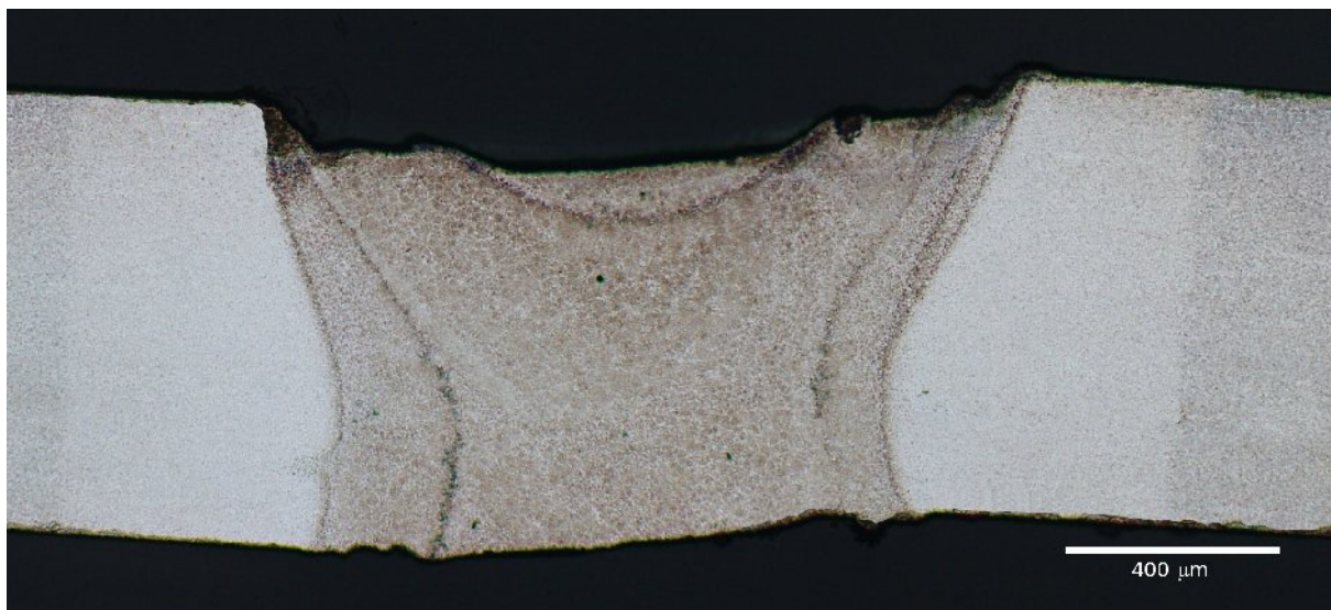
Obr. P3.20 Vzhled svarového spoje, AZ61 (tl. 0,8 mm - příčný směr), lept. nital
