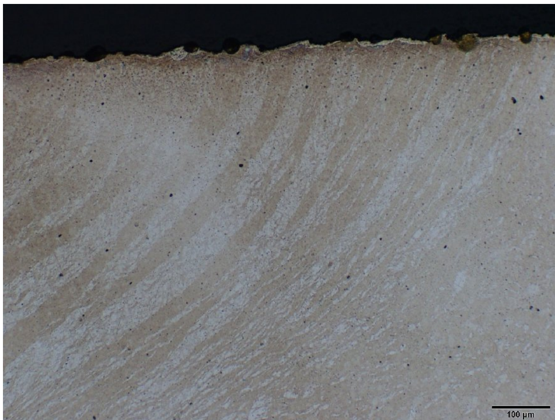
Obr. P2.11 Mikrostruktura svar. spoje II – AZ31 (tl. 1,6 mm - příčný směr) – oblast C, lept. acetic picral
