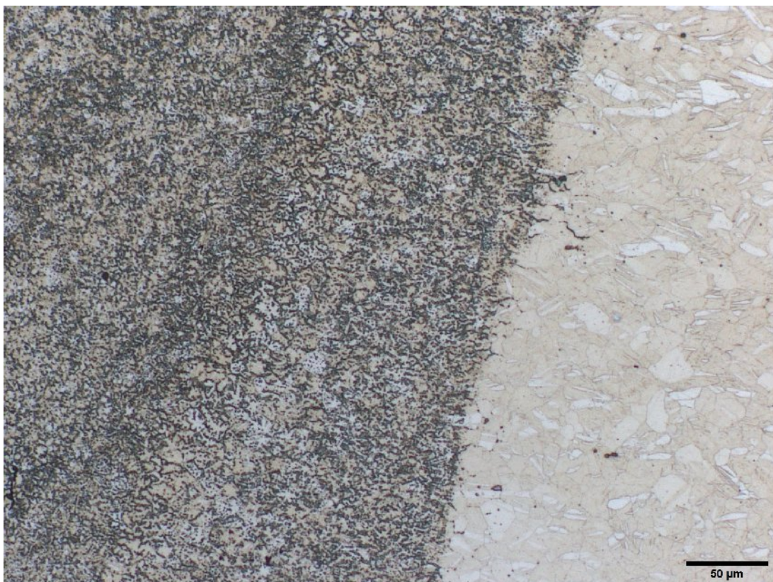
Obr. P3.12 Mikrostruktura svar. spoje II - AZ31 (tl. 1,6 mm - příčný směr) – místo B, lept. acetic picral
