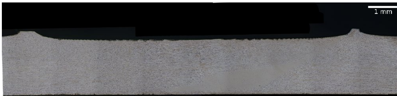
Obr. P2.33 Vzhled svarového spoje, ZE41 (tl. 2 mm - podélný směr), lept. nital
