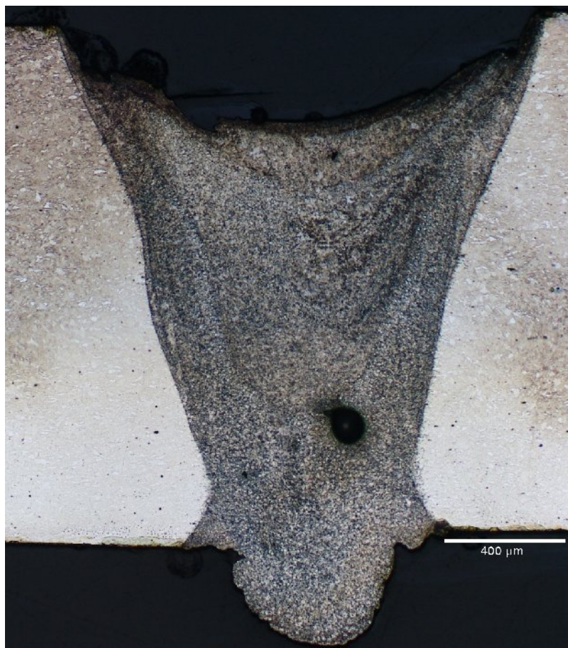
Obr. P3.10 Vzhled svarového spoje II, AZ31 (tl. 1,6 mm - příčný směr), lept. acetic picral
