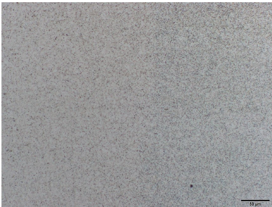
Obr. P4.18 Mikrostruktura svar. spoje - AZ61 (tl. 0,8 mm - příčný směr) – místo D, lept. nital
