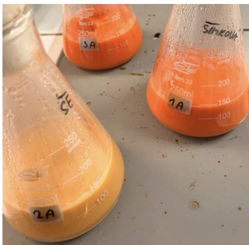
Obrázek 19: Triplikáty 1A, 2A a 3A po autolýze 24 h za stálého míchání při 55\text{ }^{\circ}\text{C} .
