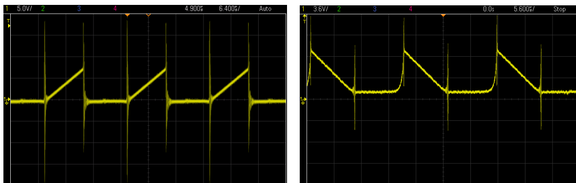
Obr. 2.10: Průběh proudu tekoucího primárním a sekundárním vinutím
