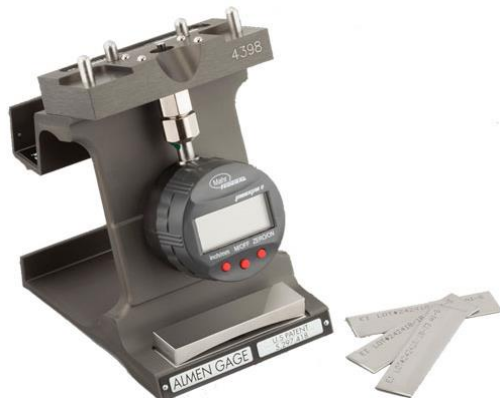
Obr. 33 Zařízení pro měření oblouku [13]
