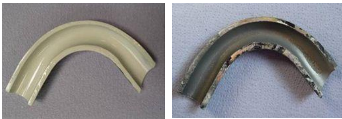
Obr. 38 Test barvou před a po otryskání [54]
