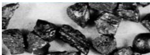
Obr. 17 Litinová drtina (vlevo) výsledný povrch (vpravo) [37]
