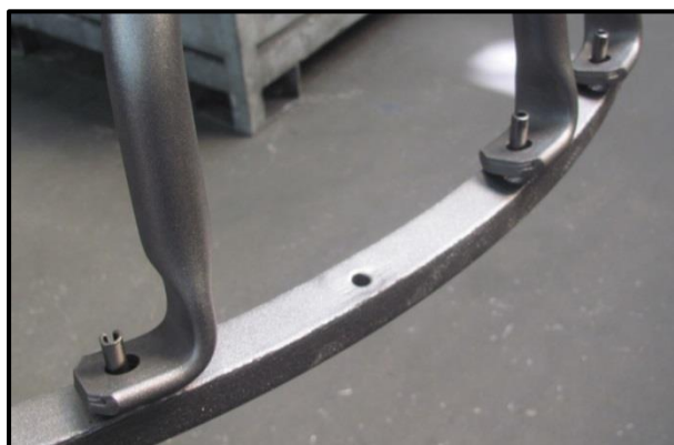
Obr. 42 Poškozený závěs (chybějící čep)
