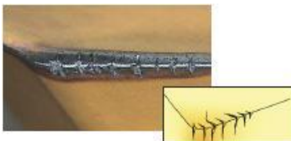
Obr. 13 Teplotní trhliny na břítu nástroje [18].
