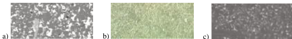
Obr. 4 Keramické řezné materiály: a) smíšená keramika; b) keramika vyztužená whiskery; c) keramika z nitridu křemíku [15].
