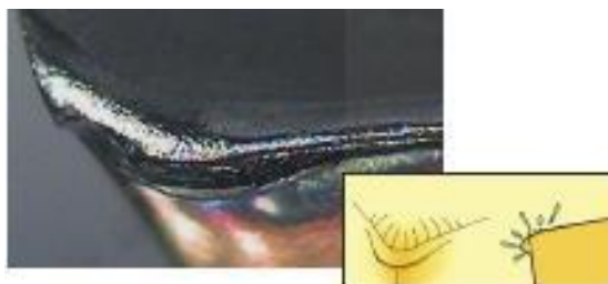
Obr. 8 Plastická deformace řezného nástroje [18]
