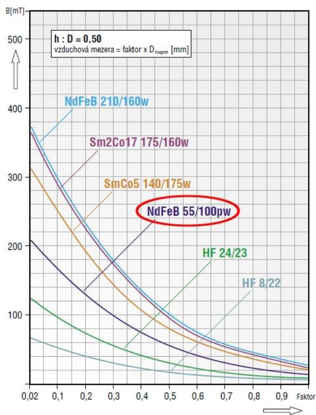
Příloha 29 (b): Hodnoty magnetické indukce pro různé geometrické faktory
