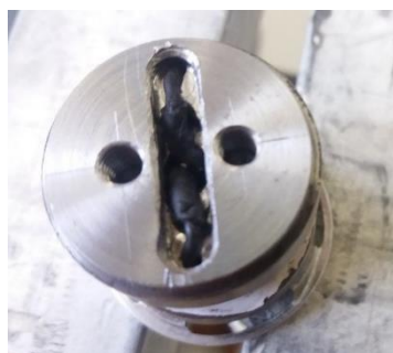
Obr. 67 Ohyb vodičů vinutí a jejich napojení
