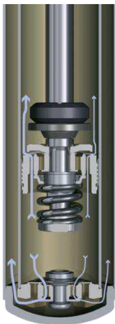
Obr. 10 Schéma proudění oleje v dvouplášťovém tlumiči při stlačování [12]
