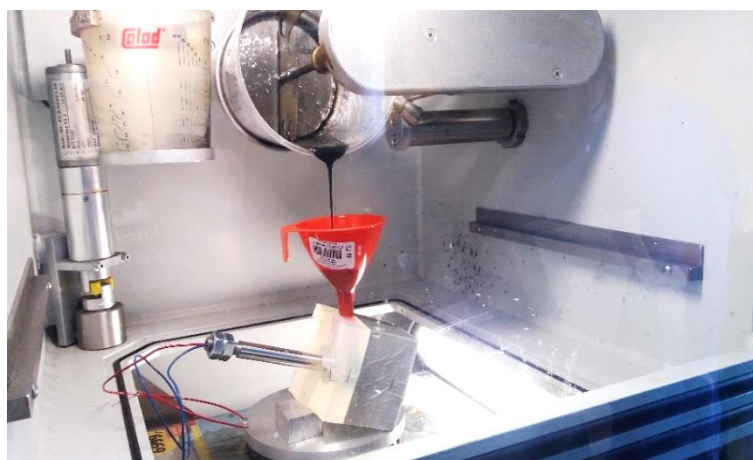
Obr. 72 Zalití cívky plastem v podtlakové komoře
