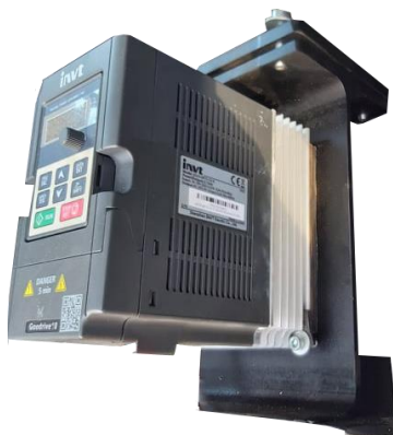
Obr. 5. 6 Osadenie frekvenčného meniča
