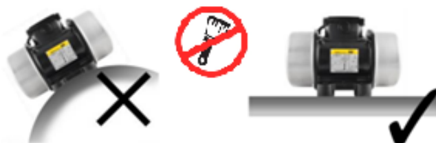
Obr. 2.19 Správna montáž vibračného motoru [9]
