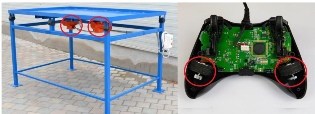
Obr. 2.18 Typické použitie vibračných motorov [7, 8]
