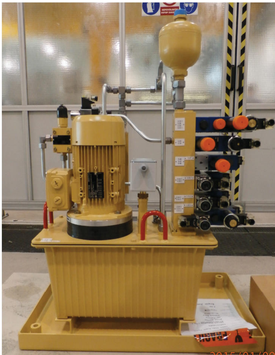
Obr. 5 Agregát velikosti S (objem nádrže: 20 litrů) [9].
