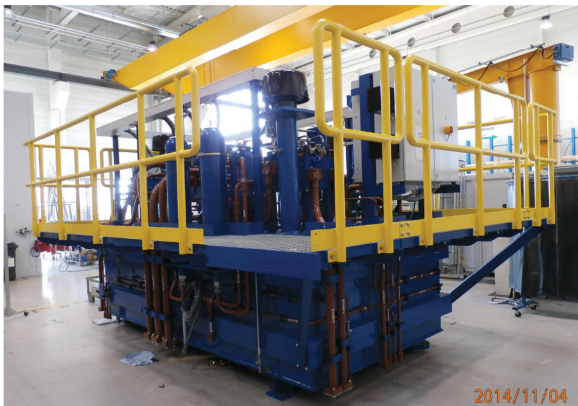
Obr. 7 Agregát velikosti XL (objem nádrže: 12 000 litrů) [9].
