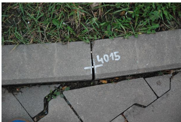
Obr. č. 5.1 Příklad stabilizace bodu sítě
