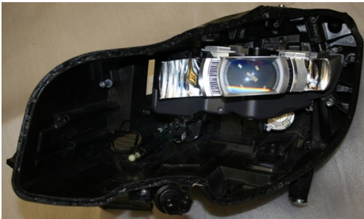
Obrázek 26: Upevnění tlumené funkce v housingu, zdroj: [vlastní]
