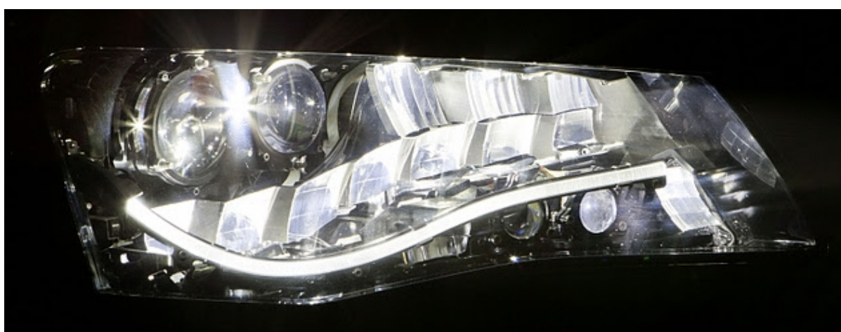
Obrázek 14: LED světlomet společnosti OPEL s dálkovou funkcí tvořenou segmenty, zdroj: [27]
