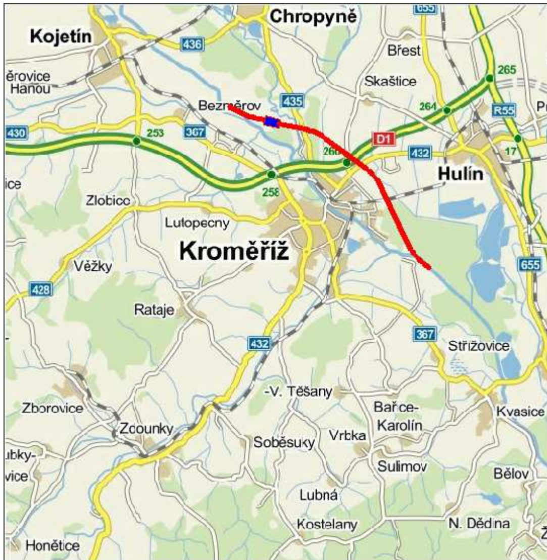
Obrázek 21: Návrh řešené trasy, modře vyznačené umístění PK, červeně kanalizovaná část trasy
