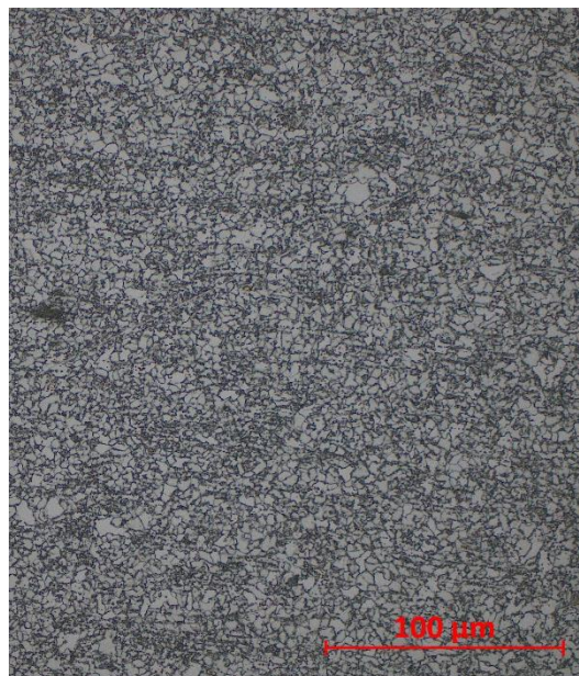
Obr. 60 Mikrostruktura oblasti normalizace z místa A2.
