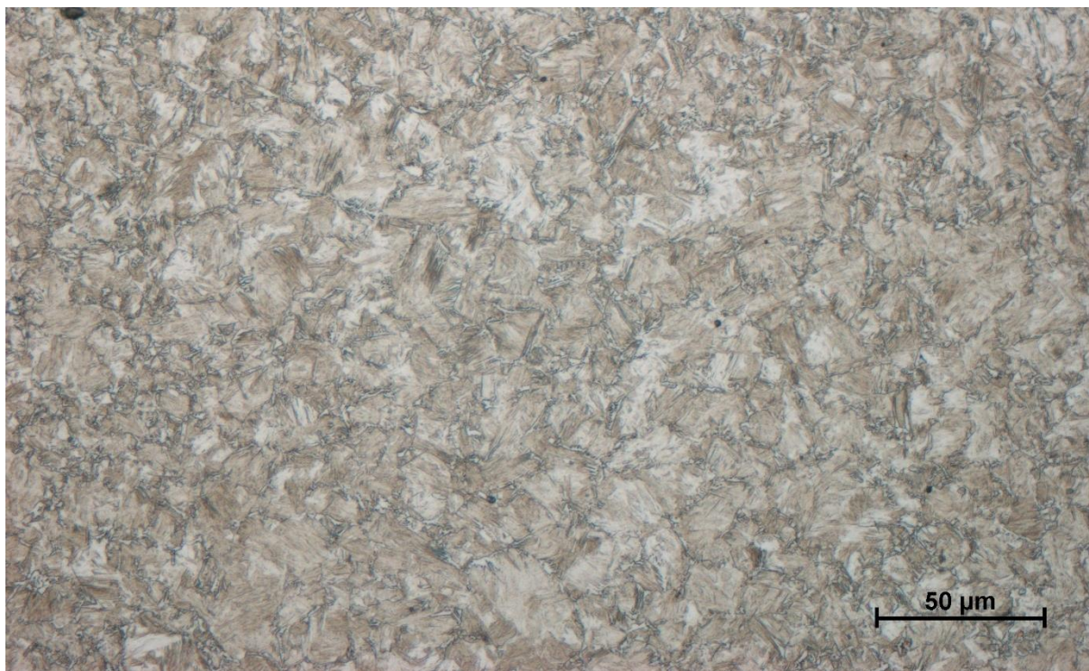
Obr. P1 Mikrostruktura svaru vzorku B.
