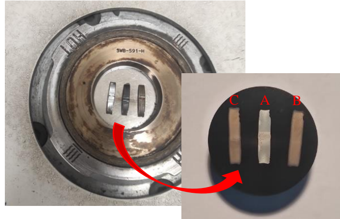
Obr. 55 Lisování a značení vzorků.
