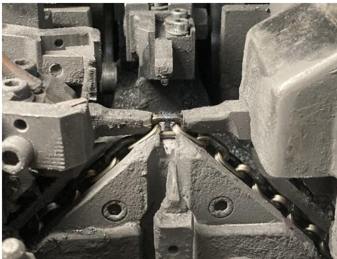
Obr. 12 Reálný proces svařování natupo.
