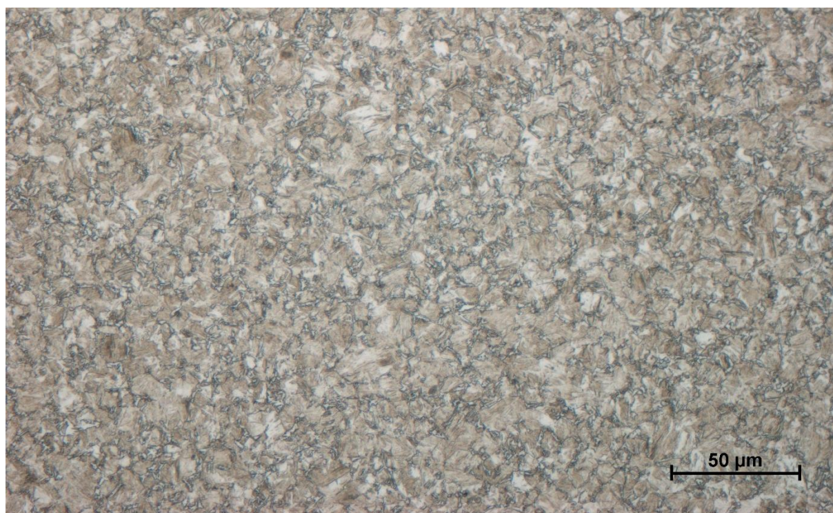
Obr. P2 Mikrostruktura tepelně ovlivněné oblasti vzorku B.
