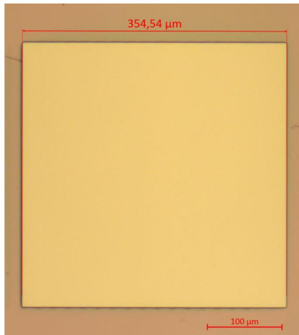
Obrázok 8.5: Rozmery otvoru v maske po expozícii a vyvolaní rezistu.
