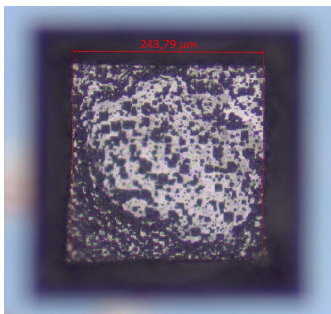
Obrázok 8.6: Vyleptaný otvor v substráte po 2 hodinách v 5% roztoku TMAH, pri teplote 90°C.
