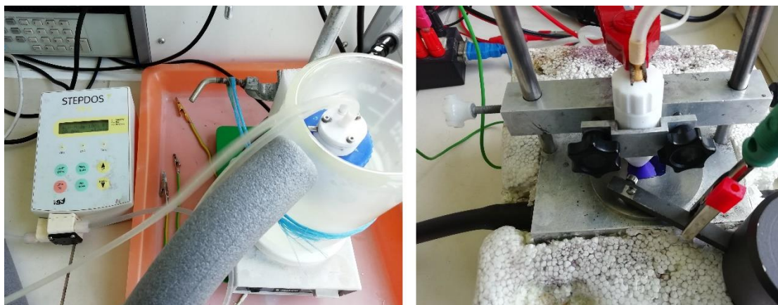
Obrázok 8.35: Elektrochemická depozičná stanica pre vytváranie vodivých vrstiev a výplní.
