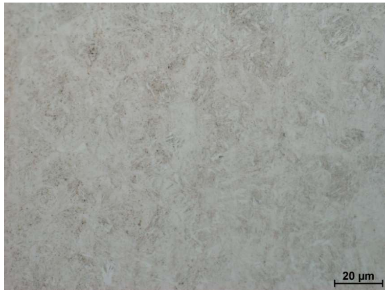
Obrázok 30: Pilotný experiment, jemný martenzit. 1000-násobné zväčšenie.
