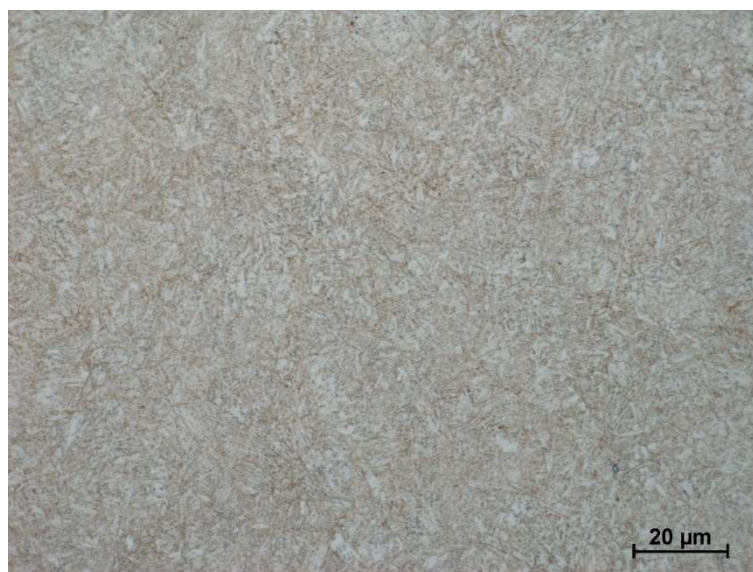
Obrázok 46: Oceľ 42CrMo4, zušľachtený stav, vysokoteplotne popustený martenzit
