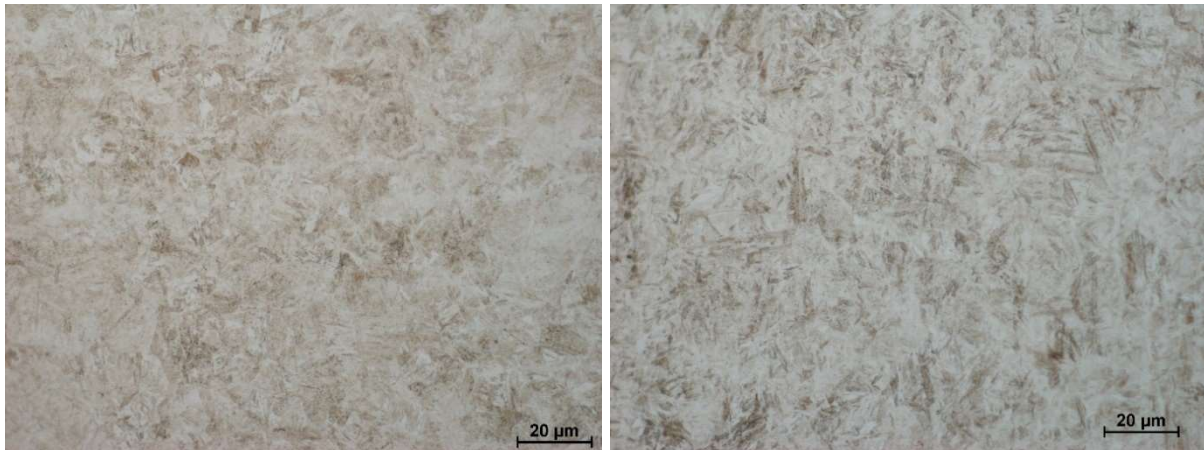
Obrázok 32 (vľavo): Porovnávací vzorka, 840 °C/15min/voda, martenzit. Obrázok 33 (vpravo): Porovnávací vzorka, 860 °C/15min/olej, martenzit.
