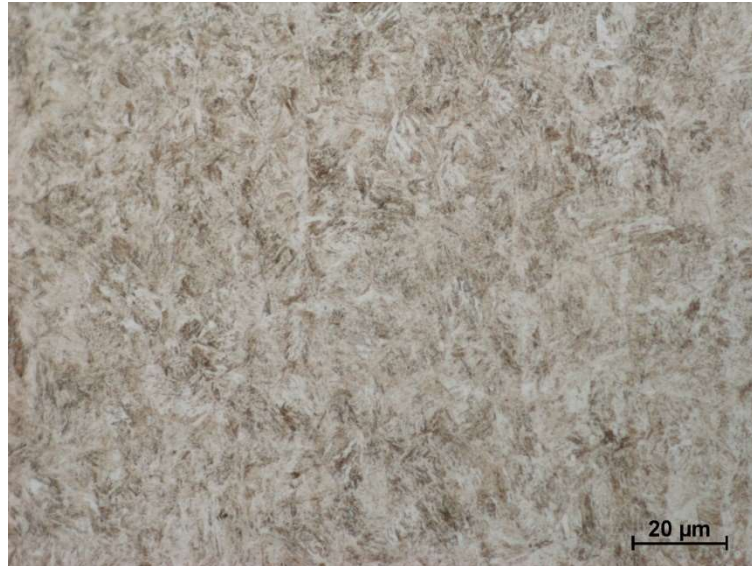
Obrázok 31: Kalenie 860 °C/8 min/voda, popustenie 180 °C/1 hod. Nízkoteplotne popustený martenzit. 1000-násobné zväčšenie.
