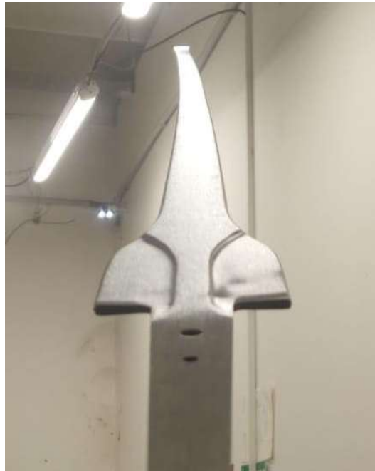
Obrázok 20: Čepel' ohnutá v rovine plochy čepele. Deformácia tohto rozsahu je často neopraviteľná.
