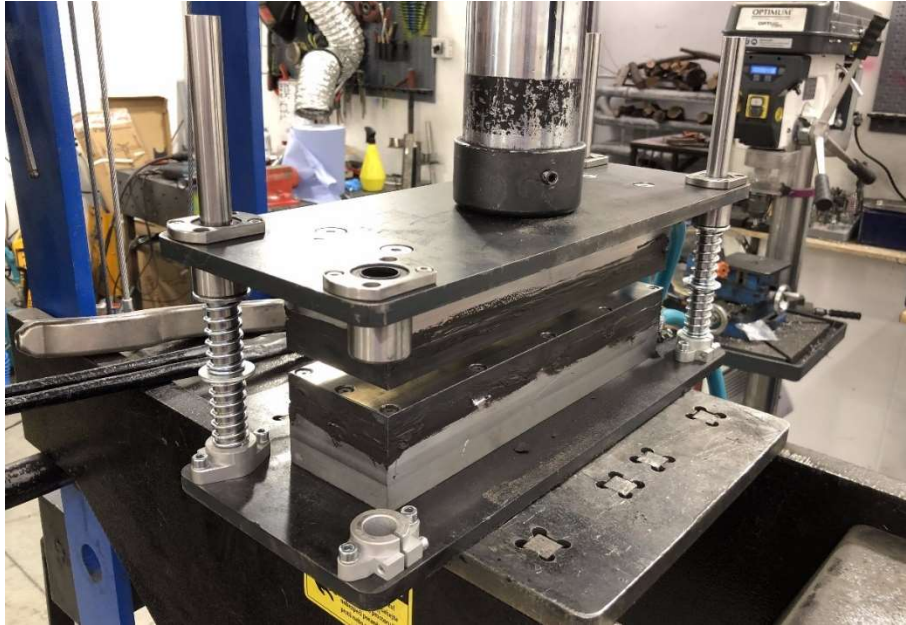
Obrázok 26: Dvojkomponentné vodou chladené kaliace čeluste, vložené v lise
