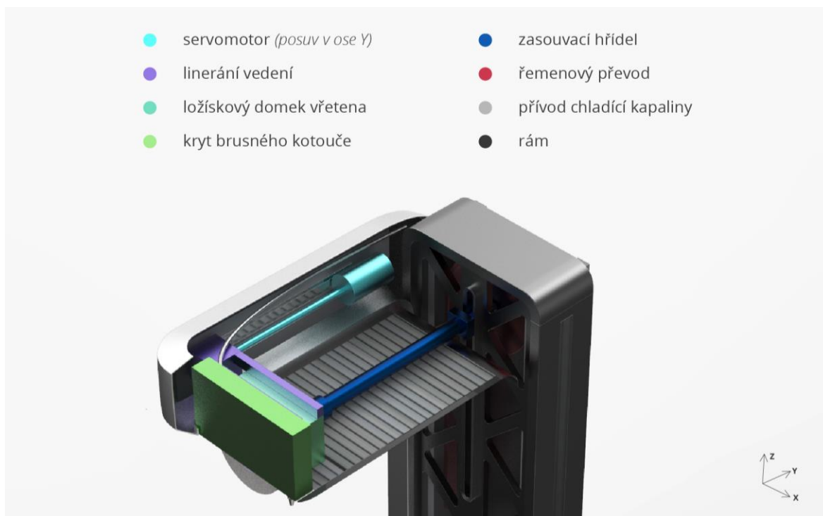
obr. 6-4 Vnitřní uspořádání vřeteníku
