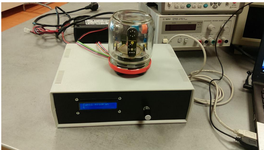
Obrázek 18: Konstrukce experimentálního prototypu elektronického nosu
