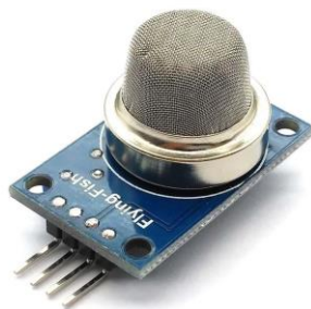
Obrázek 5: Senzor na měření plynů na bázi vodivostního senzoru. Převzato z [20]
