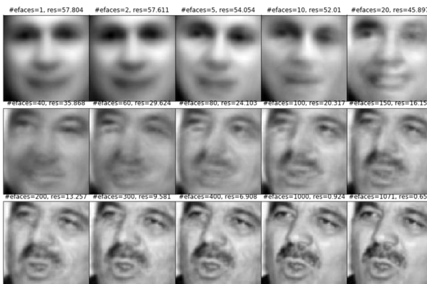
Obrázek 17: Rozpoznání obličeje pomocí metody eigenface. Převzato z [33]
