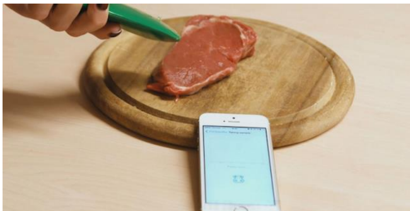
Obrázek 2: Kontrola kvality masa přenosným elektronickýmnosem. Převzato z [11]
