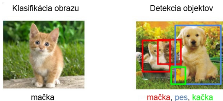
Obr. 2.5: Porovnanie klasifikácie obrazu a detekcie objektov, upravené z [25].
