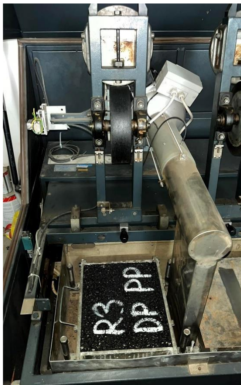
Obrázek 36: Zkušební zařízení simulující pojezdění kolem
