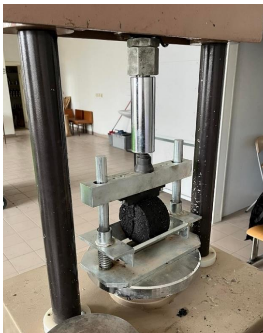
Obrázek 33: Průběh zkoušky ITS
