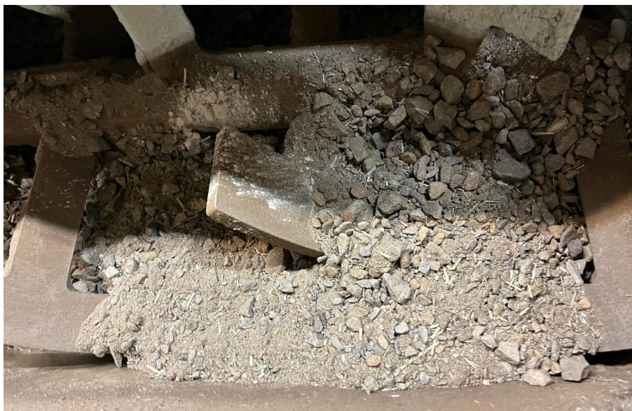
Obrázek 46: Míchání horkého kameniva a vláken při výrobě asfaltové směsi
