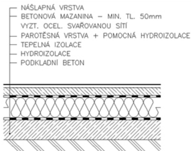
Obr. 7.11: Umístění tepelné izolace v podlaze nad terénem [31].
