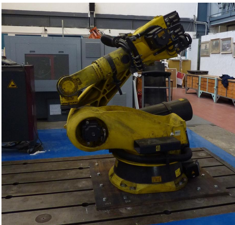
Obr. 11.3 Upevnění průmyslového robotu na základové desce
