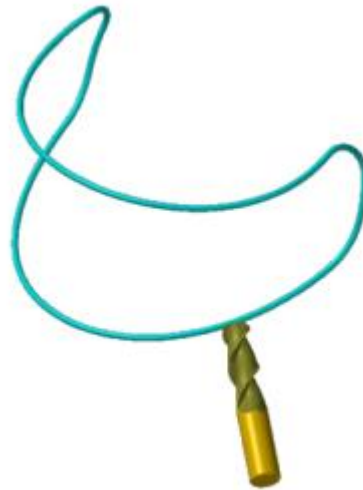
Obr. 8.28 Princip metody víceosého křivkového obrábění ( Multiaxis Curve )
