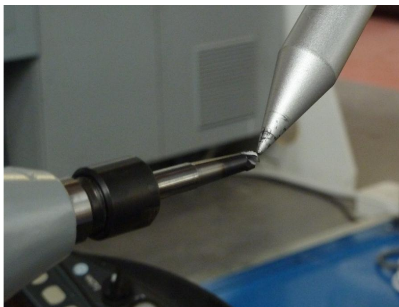
Obr. 11.6 Měření špičky nástroje pomocí měřicího hrotu
