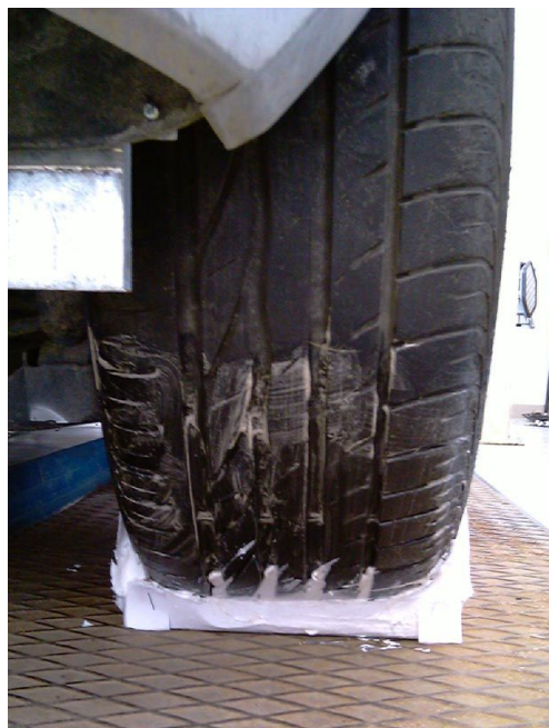
Obr. 52: Příprava odlitku pneumatiky pro měření plochy průmětu pneumatiky pomocí systému ATOS
