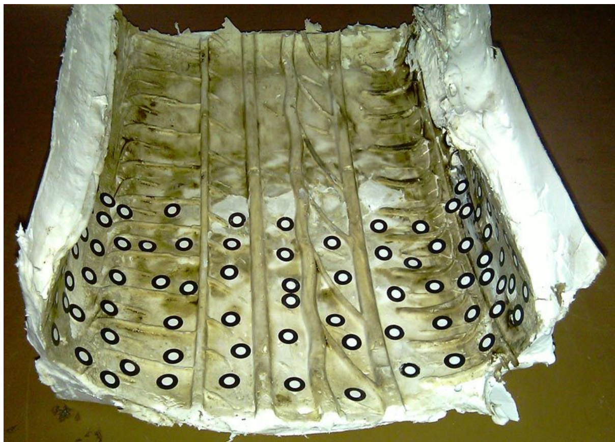
Obr. 53: Odlitek pneumatiky pro měření plochy průmětu pneumatiky pomocí systému ATOS
