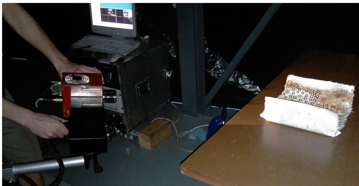
Obr. 54: Příprava systému ATOS pro měření plochy průmětu pneumatiky
