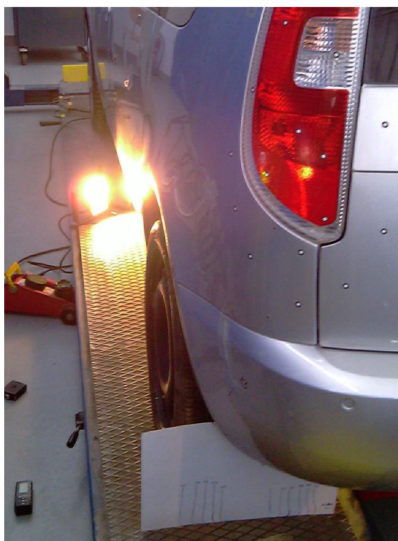
Obr. 50: Měření čelní plochy pneumatiky metodou projekce
