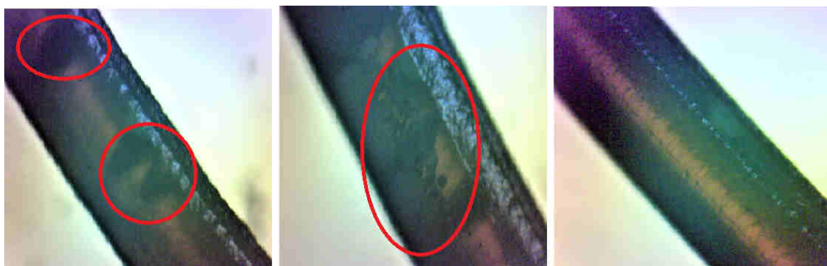
Obr. 3.1 – Vlákno protlačené tryskou č. 1 rychlostí 40 (a), 100 (b) a 140 mm · min -1 (c).
