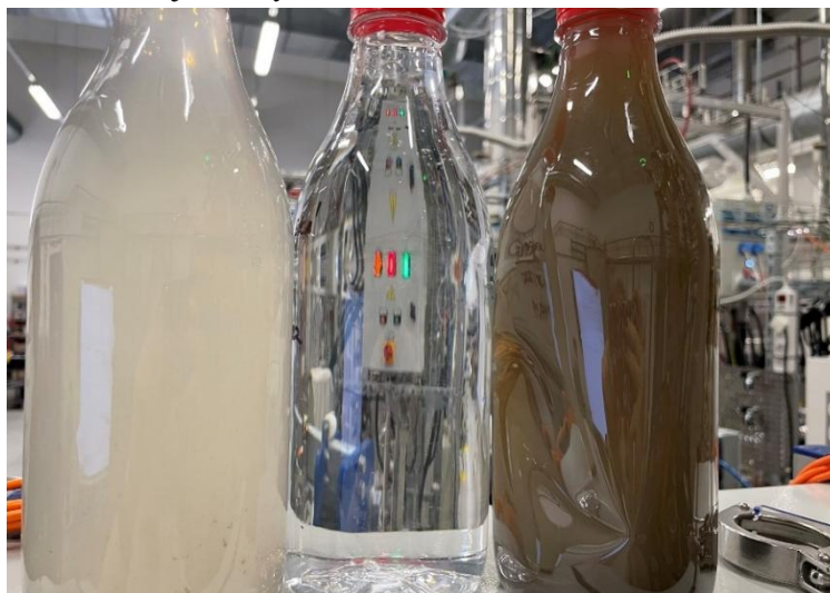
Obr. 30: Fotografie vstupní OVPP (vlevo) a výstupních proudů z odpařování pomocí MSF: destilát (uprostřed) a koncentrát (vpravo).
