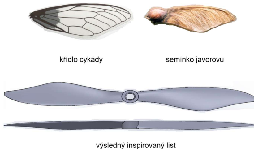
Obrázek 16: Tvar vrtule inspirovaný křídlem cikády a semínkem javoru ([9], upraveno)
