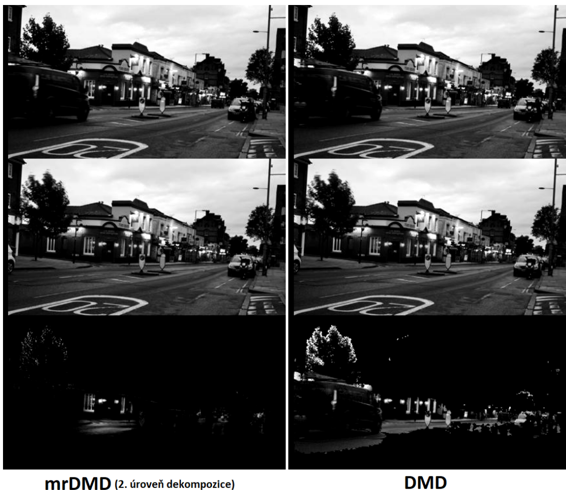
Obr. 5.3: Rozdíl mezi výsledky mrDMD a DMD metod. V horní třetině je vykreslen původní obraz, v druhé třetině je vykresleno odseparované pozadí a v dolní třetině je vykreslen obraz získaný z druhé dekompoziční úrovně mrDMD metody a obraz dynamické složky pro DMD metodu. Dynamická složka je vykreslena pomocí škálovaného vykreslení. Je patrné, že DMD metoda odseparovala nejen projíždějící auto, ale i část budov a silnice. Budovy a silnice byly odseparovány, protože se po nich pohybuje světlo jedoucího automobilu. Pohybující se světlo není v původním videu na první pohled viditelné, ovšem pomocí mrDMD (konkrétně z druhé dekompoziční úrovně) jsme toto světlo schopni odseparovat.
