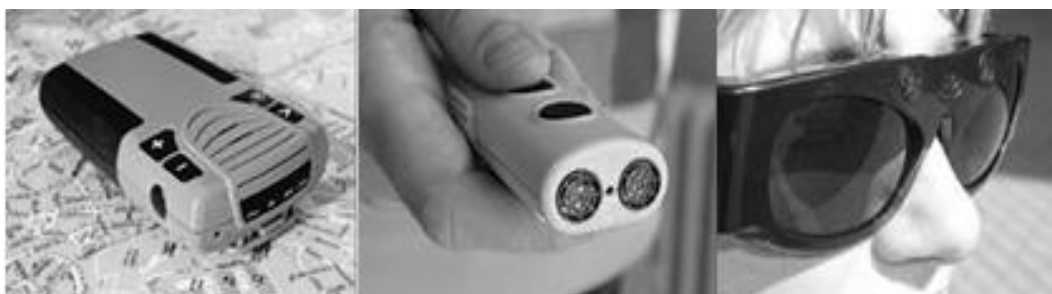
Obrázek 18 Navigační jednotka, rádiový vysílač do ruky a zabudovaný v brýlích [22]
