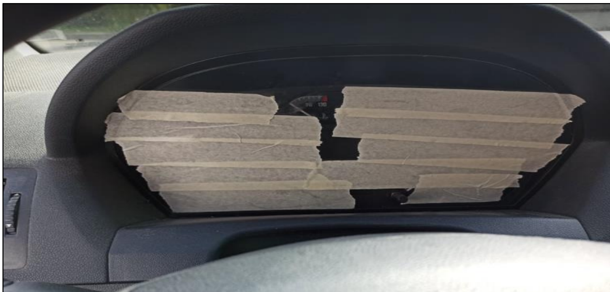
Obr. č. 39 – Ukázka zakrytí tachometru testovaného vozidla [vlastní]
