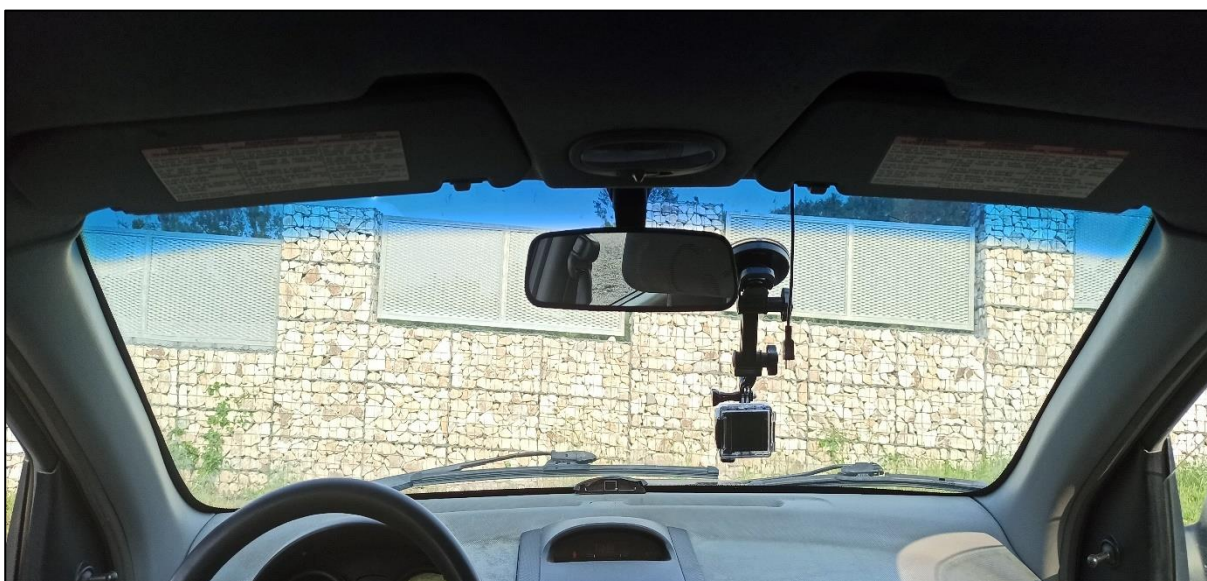
Obr. č. 40 – Ukázka připevnění měřicího přístroje v testovaném vozidle [vlastní]
