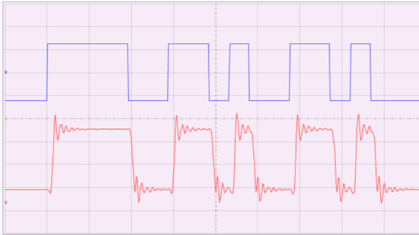
Obr.4.14. První fáze demodulace ASK signálu
