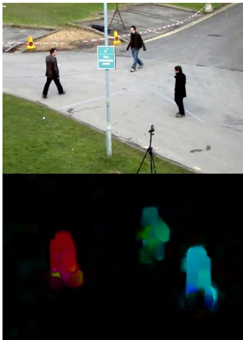
Obrázek 2.4: Obrázek graficky zobrazuje funkcionalitu metody Farneback. Muž nalevo se pohybuje rychleji než muž uprostřed, tudíž jeho pohybová stopa na spodním obrázku má více červený odstín. Muž napravo stojí na místě a pohybuje se minimálně, proto je reprezentován jako odstín modré. Pozadí je statické, a proto je černé. Obrázek pochází z oficiálních stránek OpenCV [22].
