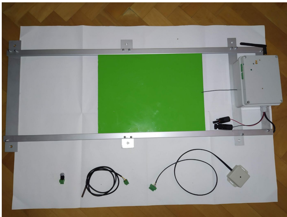
Obr. 4.5: Konstrukce dvířek s externími senzory
