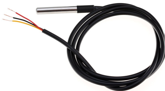
Obr. 2.4: Externí čidlo teploty DS18B20 [12]
