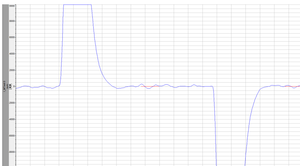
Obrázek 21: Signál pocházející z porušené mikroelektrody ponořené do roztoku
