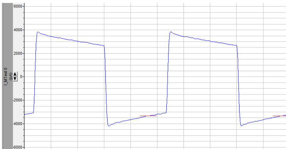
Obrázek 22: Signál pocházející z neporušené mikroelektrody ponořené do roztoku
