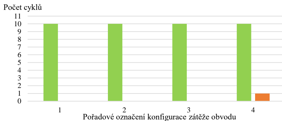
Obrázek 23 – Počty úspěšných a neúspěšných vypínacích cyklů s použitím materiálu Poly 1.
