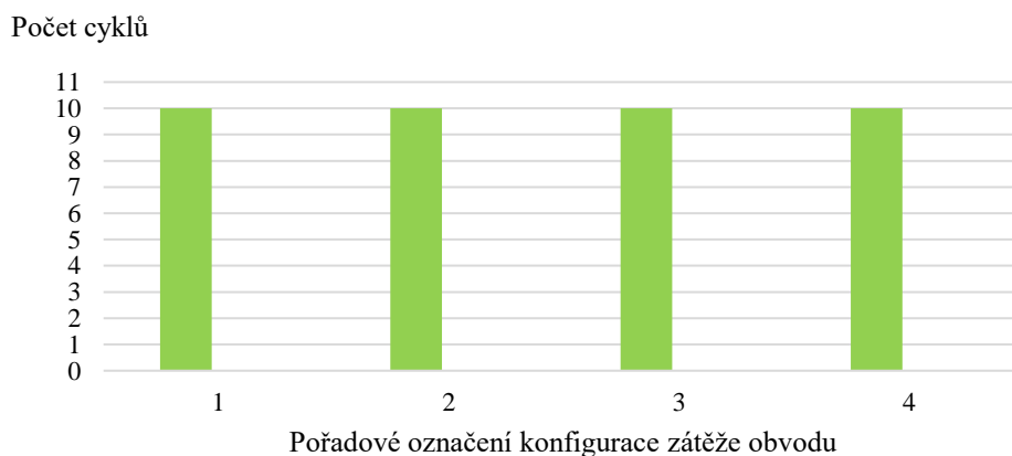
Obrázek 25 - Počty úspěšných a neúspěšných vypínacích cyklů s použitím materiálu Poly 3.
