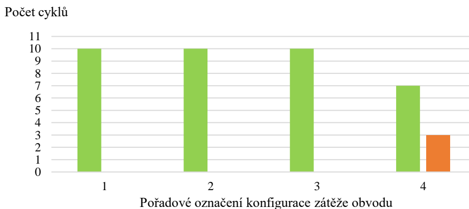
Obrázek 24 - Počty úspěšných a neúspěšných vypínacích cyklů s použitím materiálu Poly 2.
